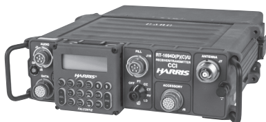
1. ábra AN/PRC–150(C) HF/VHF korszerű harcászati rádió
