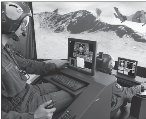
6. kép Helikopter taktikaiszimulátor-személyzetének egymás mögötti elhelyezése
