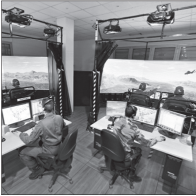
8. kép Harcászati helikopterszimulátor alájátszó és oktató munkaállomás
