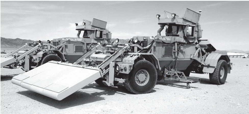
6. ábra Husky páncélozott aknakutató gépjármű 43
