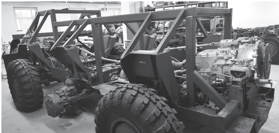
4. ábra BTR-80 kerekesharcjármű-metszet szaktanteremben (Fotó: Végvári Zsolt)
