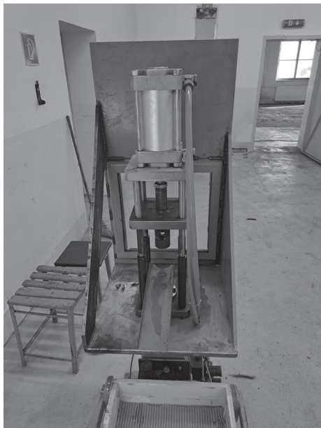
2. ábra Pneumatikus lőszerészéthúzó gép (A szerző felvétele)
