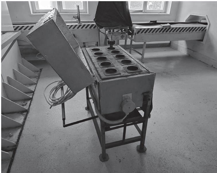
5. ábra Robbanóanyag-kiolvasztó berendezés 82 mm-es repesz aknagránátokhoz (A szerző felvétele)
