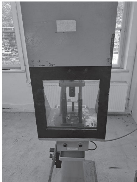
3. ábra Pneumatikus lőszerészéthúzó gép a kezelő felől (A szerző felvétele)
