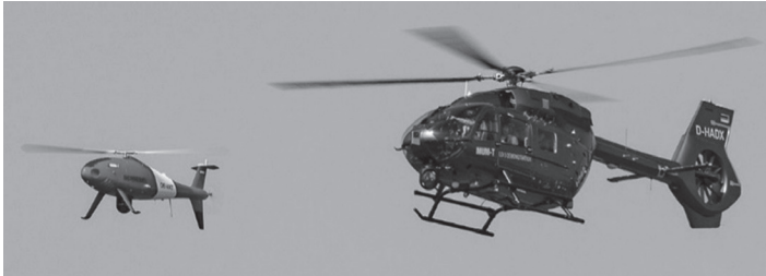
3. ábra Az Airbus H145 típusú helikopteréből irányítanak egy Schiebel-100 pilóta nélküli forgószárnyast 25
