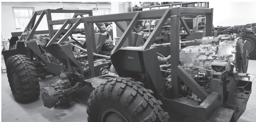
4. ábra BTR-80 kerekesharcjármű-metszet szaktanteremben (Fotó: Végvári Zsolt)
