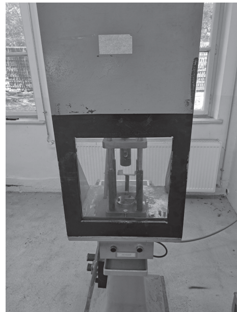
3. ábra Pneumatikus lőszer széthúzó gép a kezelő felől (A szerző felvétele)
