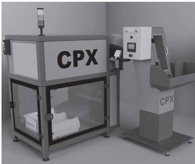
6. ábra Automatizált lövészlőszer lövedékkítő gép tervezett felépítése
