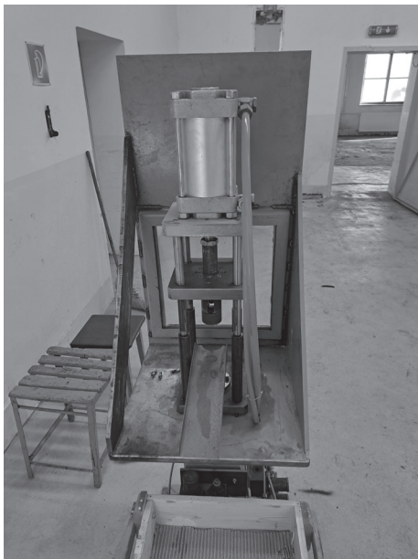
2. ábra Pneumatikus lőszer széthúzó gép (A szerző felvétele)
