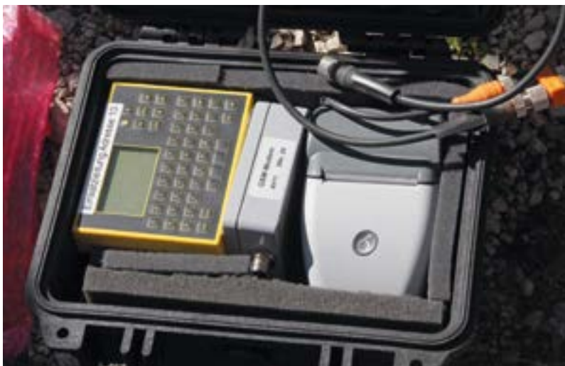
9. ÁBRA. A Cavellink barlangi szöveges kommunikációs rendszer (Fotó: Zentay Péter)
