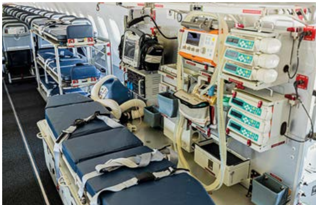
4. ÁBRA. A Magyar Honvédség Airbus A319 MEDEVAC intenzív ellátó modulja (Fotó: HM Zrínyi Nkft. / honvedelem.hu / Kertész László)
