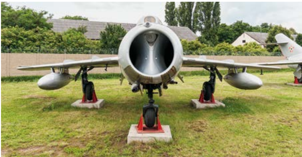
3. ÁBRA. A MiG-15bis vadászpilóta repülőgép orr-része a gépágyúkkal (Fotó: Illés András; Hadtörténeli Múzeum, Haditechnikai Gyűjtemény. A 912 oldalszámú MiG-15bis vadászpilóta repülőgép, RepTár, Szolnok)
