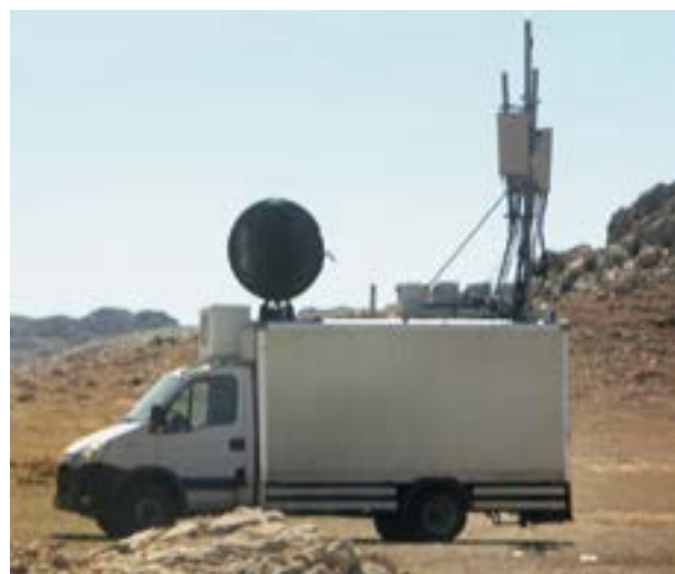
8. ÁBRA. Kitelepített átjátszóállomás, amely a mentés alatt a mobil-, illetve a műholdas kommunikációt biztosította (Fotó: Zentay Péter)
