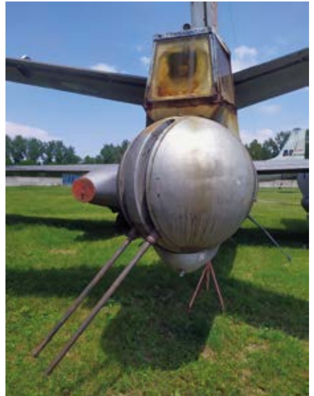
5. ÁBRA. NR-23 gépágyúk mozgatható lőtoronyban (Fotó: Szatmári András; Hadtörténeli Múzeum, Haditechnikai Gyűjtemény, 55 oldalszámú Il-28 harcászati könnyűbombázó repülőgép, Szolnok)
