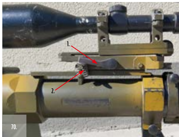
70. ÁBRA. Egy eredeti Nikko Stirling puskatávcső és a módosított irányzékszerelék (1. rugólemez-szorítókar, 2. racsnis rögzítőív)
