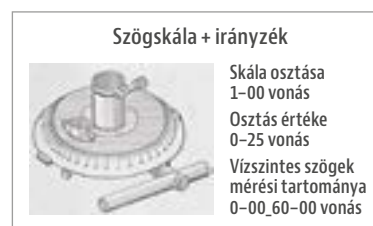
7. ÁBRA. A VR-2 szélfegyver (A szerző szerkesztése [12; 4–8.] alapján)
