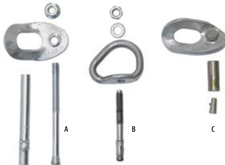
11. ÁBRA. A rögzítések alkatrészei: A) hüvelyes rögzítésű falcsavar egyenes nittfüllel, B) alapcsavar ringgel, C) önfúró dübel a feszítőkúppal, és csavart nittfüllel (Fotó: Zentay Péter)
