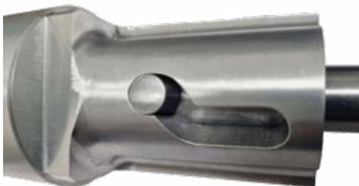
16. ÁBRA. A cikloidális kényszerpálya, egy oktatási demonstrátoron (A szerző felvétele)
