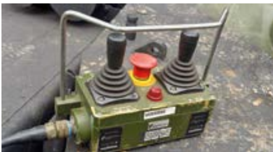
31. ÁBRA. A Bergepanzer 3 Büffel emelődarujának vezérlőegysége a) és a rugós vonóháromszög csatlakoztatása b) [39]
