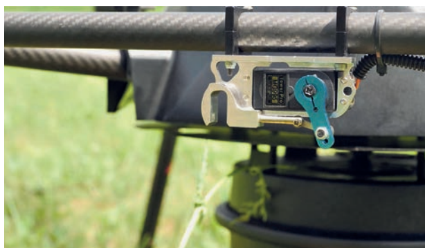
15. ÁBRA. A teherhordó zárszerkezet nyitott helyzetben [8]
