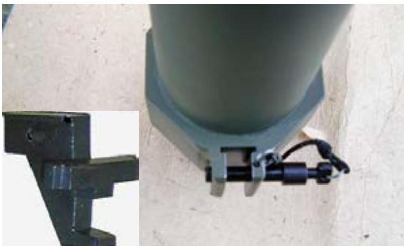
63. ÁBRA. A toktest a hátsó adapter T sínrel és a rögzítő rugós csappal, valamint a biztosító fonallal. (Balra lent a kis képen a hátsó adapter-kapcsolófej)
