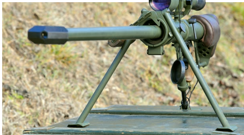
64. ÁBRA. A melső villaláb és a fogantyúszerkezet szembenézeten (Fotó: HM Zrínyi Nkft. / Rác Tünde)
