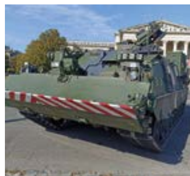
28. ÁBRA. A PzB 3 Buffel tololapja menethelyzetben (Fotó: Farkas Zoltán)
