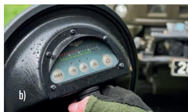
4. ÁBRA. Az NR-változat radarantennái a) és az NR-900 radarfej kijelzője b) [4]
