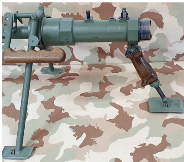
59. ÁBRA. A szerelt tok két változatban. Az a) ábrán három lábon és szerelt csővel, továbbá hátsó lábbal kiegészítve, távcsőszerelék nélkül. A b) ábrán felhajtott villalábakkal, szerelt csővel, szerelt tusával és a hátsó PKM-kapcsoló adapterrel, valamint a távcsőszerelékkal kiegészítve
