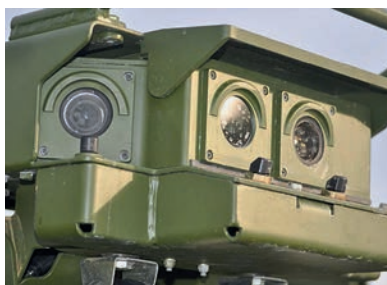
29. ÁBRA. Kappa optronics kamera páncélvédelemmel, lecsukható védőfedéllel [34]
