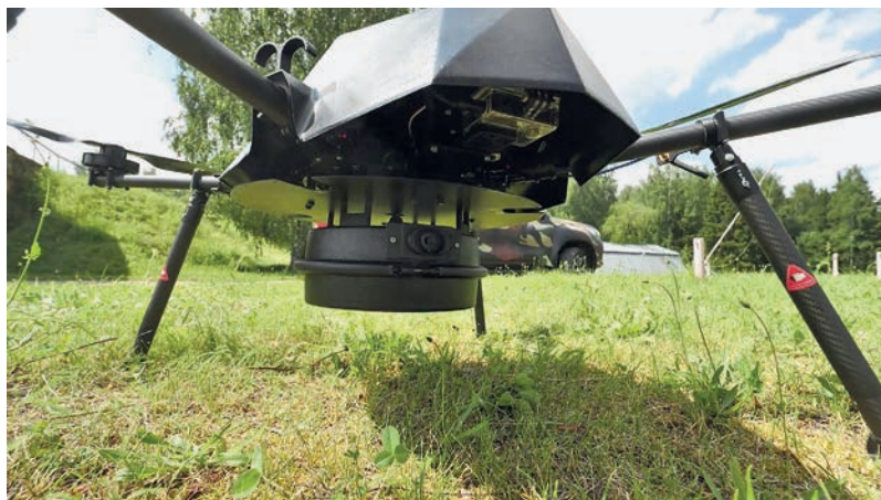
10. ÁBRA. A „Szitakötő” optikai kamerája és radarja [8]
