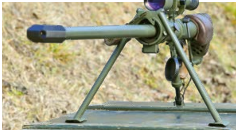
64. ÁBRA. A mellő villaláb és a fogantyúszerkezet szembenézetben (Fotó: HM Zrínyi Nkft. / Rácz Tünde)
