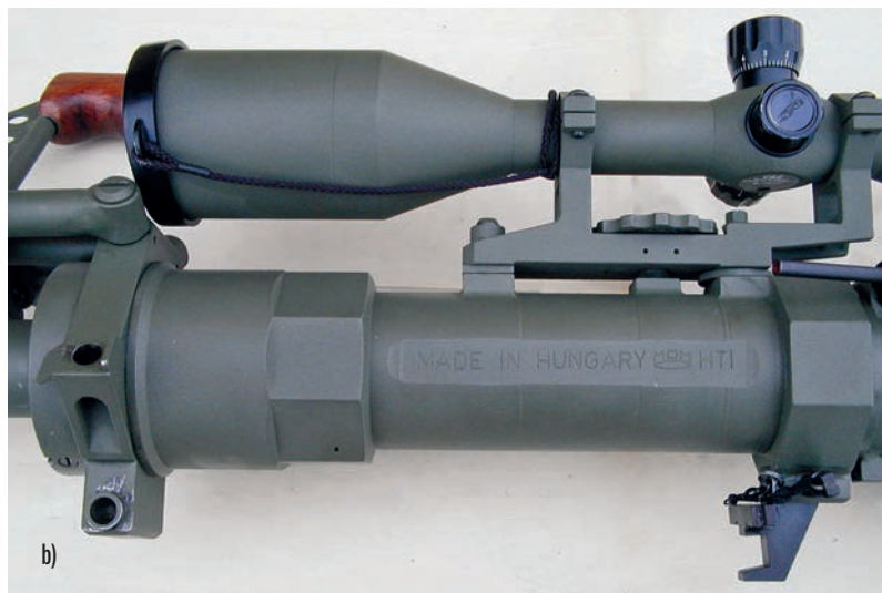
59. ÁBRA. A szerelt tok két változatban. Az a) ábrán három lábon és szerelt csővel, továbbá hátsó lábbal kiegészítve, távcsőszerelék nélkül. A b) ábrán felhajtott villalábakkal, szerelt csővel, szerelt tusával és a hátsó PKM-kapcsoló adapterrel, valamint a távcsőszerelékkal kiegészítve
