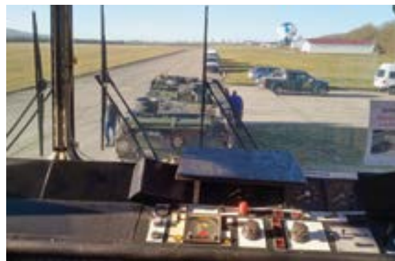
16. ÁBRA. Az MF 60 mérőjármű műszerfalán a méréshez szükséges ellenállások forgatókapcsolói és visszajelző műszerei találhatóak [5]
