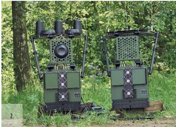
2. ÁBRA. A KOTOMKA-NR (balra) és a KOTOMKA-WJ (jobbra) berendezések munkavégzéshez előkészítve [4]
