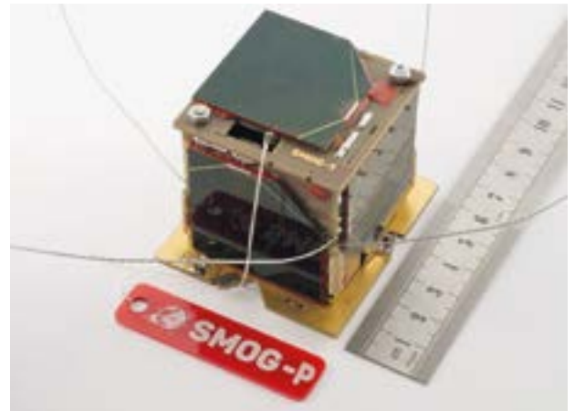
1. ÁBRA. SMOG-P, a világalós sikeres 1PQ műhold (A szerzők felvétele)
