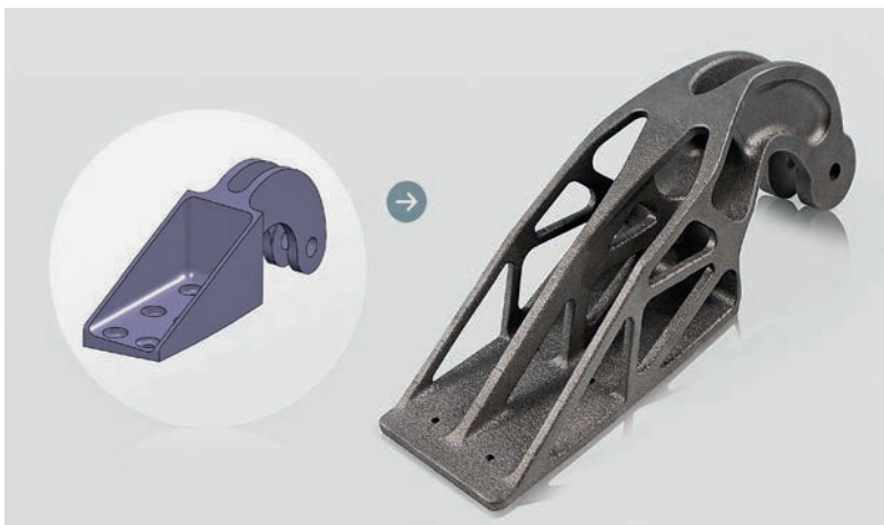
11. ÁBRA. A topológiailag optimalizált (jobbra) 3D-s nyomtatott Airbus repülőalkatrész tömegét 50%-kal csökkentették (balra: konvencionális tervezési- és gyártástechnológiával előállított alkatrész grafikája) [29]
