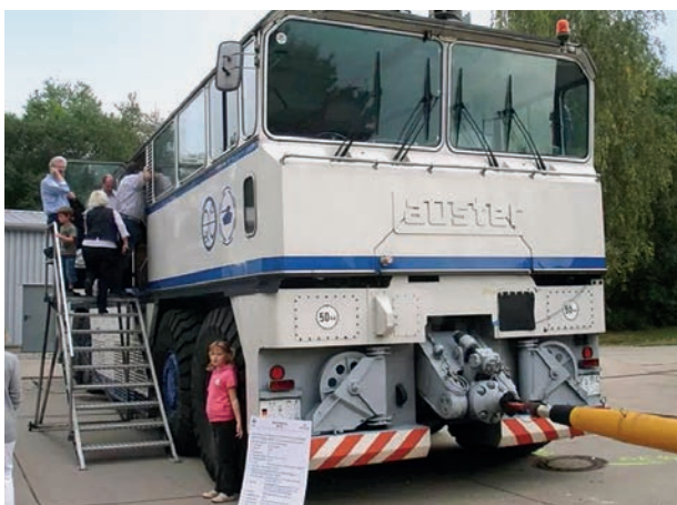
15. ÁBRA. Az MF 60 mérőjármű hátsó részén kialakított csörlőberendezés, és annak terelőgörgői a vonófej két oldalán [5]
