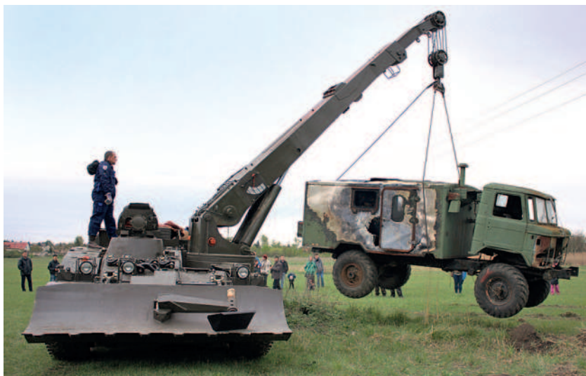
13. ÁBRA. A JVBT-55A daruzási-mentő jármű műszaki-mentő jármű (Forrás: HM Zrínyi Nkft. archív)
