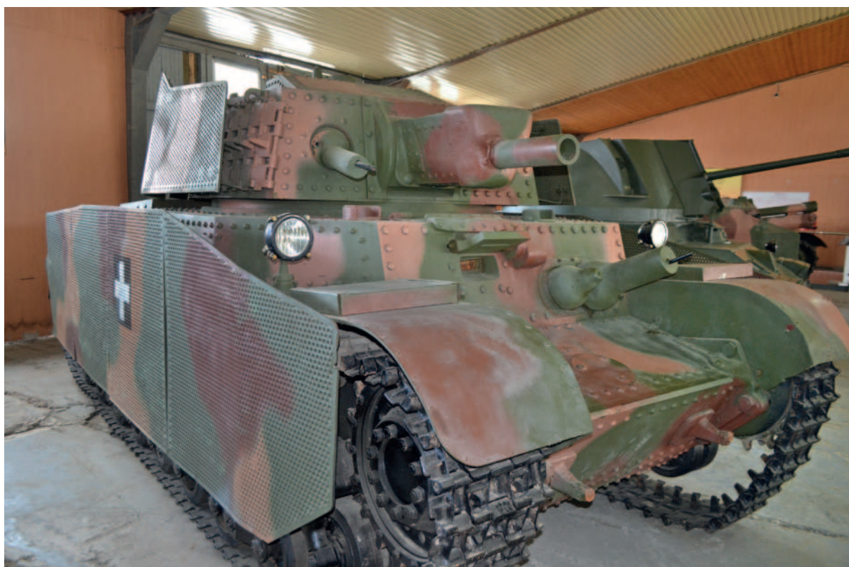
7. ÁBRA. A II. világháborús magyar 41M Turán 2 harckocsi, a torony és a páncéltest oldalát védő lyukacsos kiegészítő oldalpáncéllal (A szerző felvétele)
