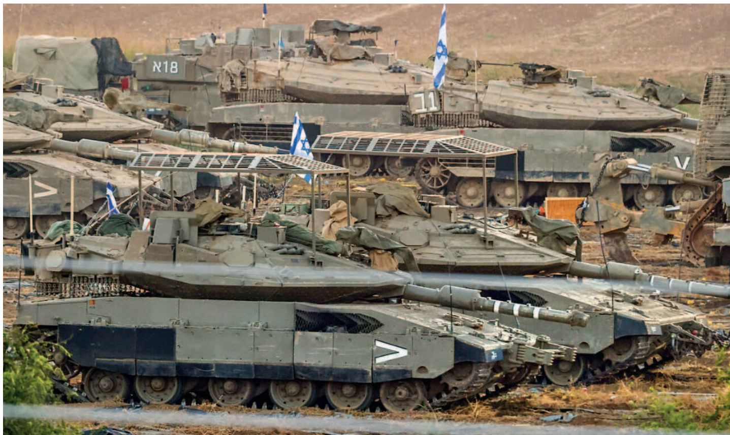
12. ÁBRA. Merkava Mk 4 izraeli harckocsik drónvédelmi rácspáncéllal felszerelve a gázai hadművelet elején [14]
