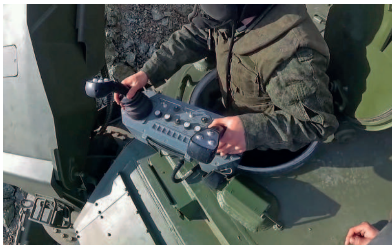
7. ÁBRA. A kotrókar és a kapcsolt munkaszerv irányítása vezérlőpanelről [8]
