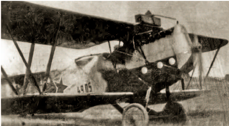
7. ÁBRA. A 225 LE-s Daimler-motorral felszerelt 49.05-ös. A rendelkezésre álló fotók alapján a vörös csillagos Phönixeket ezzel a motorral látták el (Forrás: Winkler Aero Archiv)
