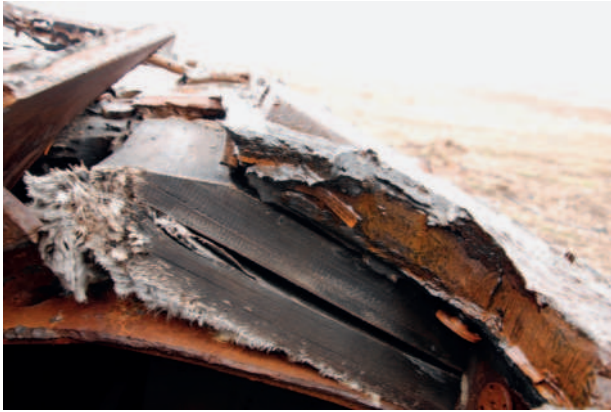
4. ÁBRA. A „0”-ponti lőtérén céltárgyként „meggyötört” egyik hazai T-72A harckocsi homlokpáncéljának szendvicsszerkezete, bal oldalt a homlokpáncél belső és külső fémrétegei között kitüremkedő textiltakelít rétegekkel (A szerző felvétele)
