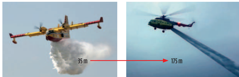
11. ÁBRA. A hagyományos (bal) és az I4F technológia (jobb) kibocsájtási képe közötti különbség. [9] Az eltérő módszer 2,4 kgm 2 fedettségi szint esetén 35 m (bal) és 175 m (jobb) hosszú hatékony oltási sáv kialakítását teszi lehetővé, jelentős előnyt biztosítva az új technológiának
