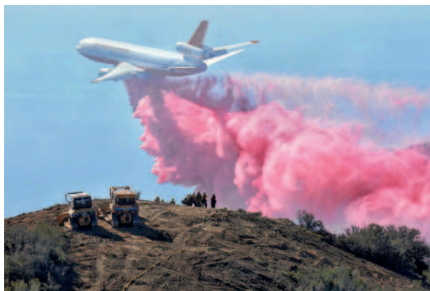
5. ÁBRA. A kibocsátott oltóanyag a levegővel ütközve szétporlad, az apró cseppek a légmozgással eltávoznak és nem vesznek részt az égéstér hűtésében. Noha a kibocsátás meglehetősen látványos, a hatékonyság sajnos nem az elérhető legjobb [9]
