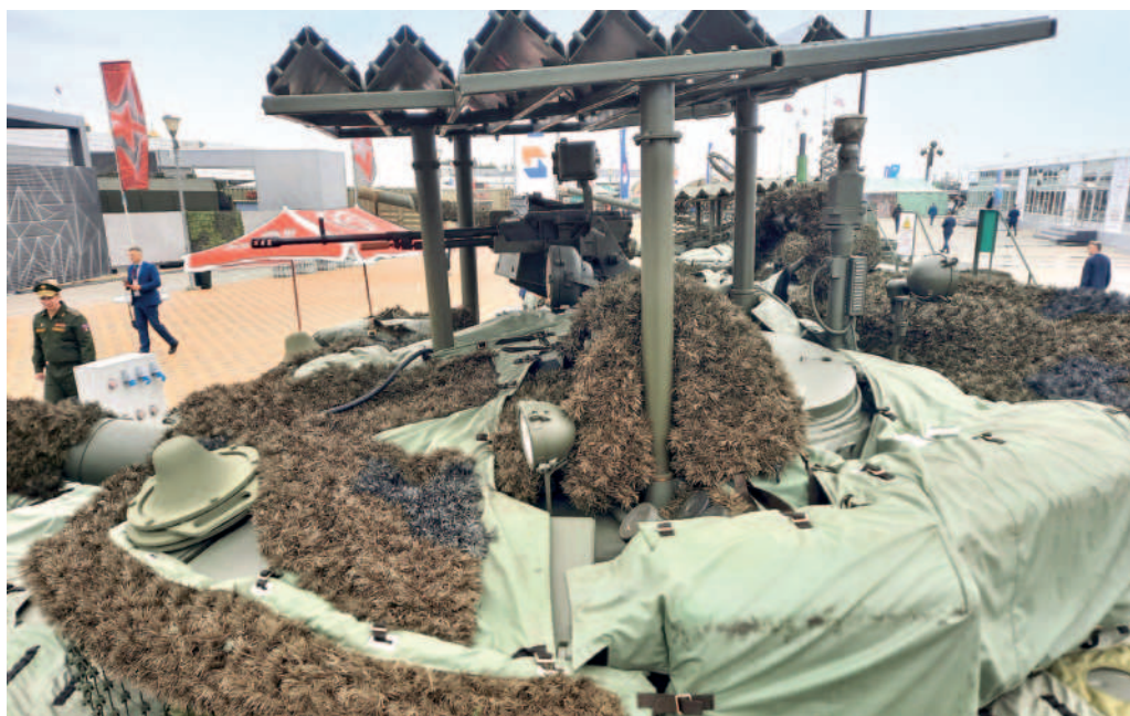
11. ÁBRA. Az ARMY-2023 haditechnikai kiállításon bemutatott drónvédelmi rács T-72B3M harckocsi tornyára szerelve 15 [13]
