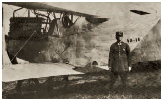
10. ÁBRA. Román tiszt áll a 49.11-es számú gép előtt. Megfigyelhető az üzemi alapozó festés, és a kis gyári szám (Forrás: Winkler Aero Archiv)
