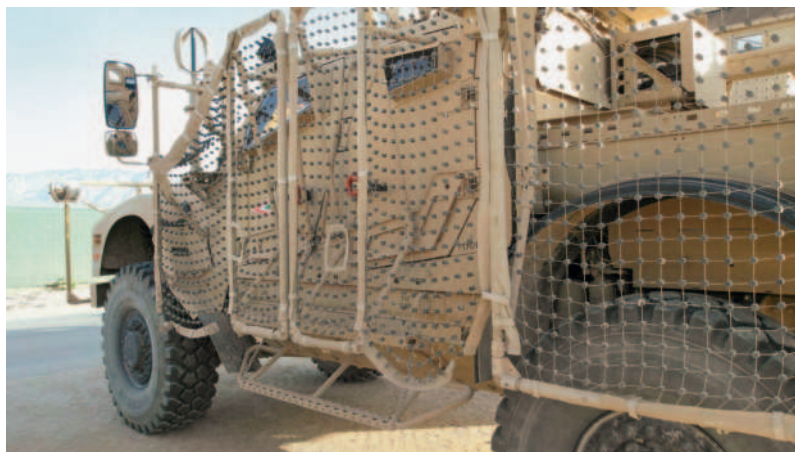
10. ÁBRA. A Mazár-e Sharifban (Afganisztán) használt egyik magyar felségjelű M-ATV hálópáncélatozása (A szerző felvétele)
