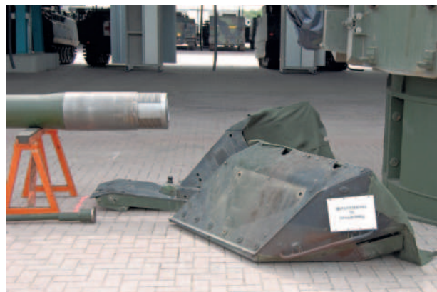
6. ÁBRA. A Leopard 2A5 harckocsitorony mellső NERA-elemei [10]
