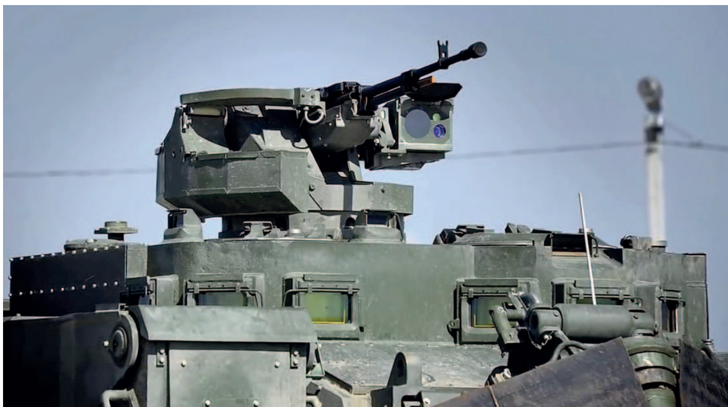
2. ÁBRA. A 12,7 mm-es Kord géppuska, a célok felderítését segítő kamerákkal [5]
