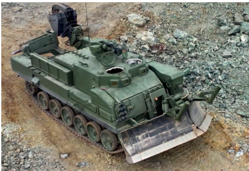
5. ÁBRA. Jelduplikátorok az UBIM tolólapja fölött [8]
