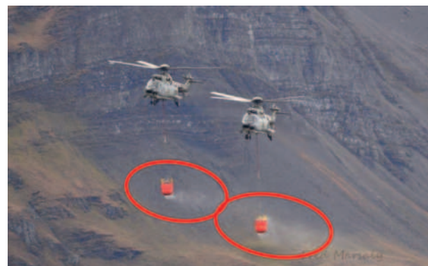
4. ÁBRA. A szállítási veszteség igazolása. A szállítóedény tetején és alján folyamatos az oltóanyag-veszteség [13]
