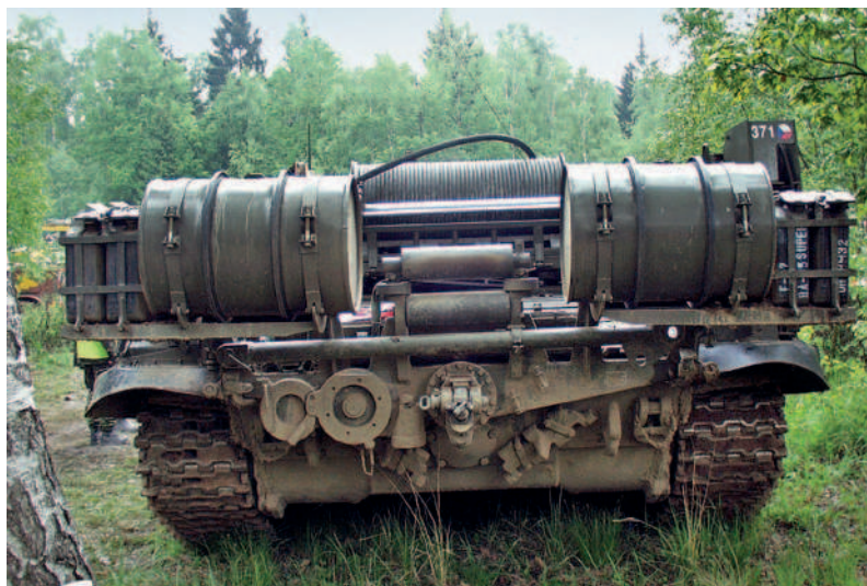
15. ÁBRA. A VT-72B műszaki-mentő jármű hátulnézete. A hordók között a gyorstekercselő dob, és előtte a két kötélfető henger látható [19]
