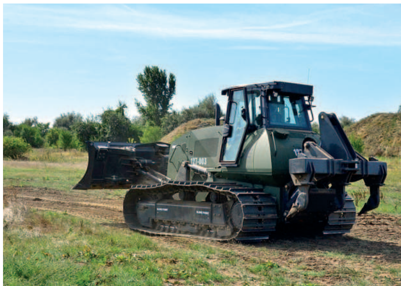
6. ÁBRA. A CASE 1650M lánctalpas bulldózer talajszaggató munkaszerve [10]
