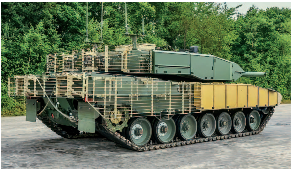
5. ÁBRA. A Leopard 2A4C4C harckocsihoz rendszerített urban kit kísérleti elrendezése, kiegészítő páncélelemekkel. E pótpáncéltartó alapján fejlesztették a magyar Leopard 2A7HU fel- és leszerelhető pótpáncéltartó (Forrás: KMW)
