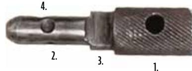
9. ÁBRA. A zárfogantyú részei: 1. zárfogantyú, 2. zármozgatócsap, 3. lapoltnyak/biztosító, 4. rögzítőfészek
