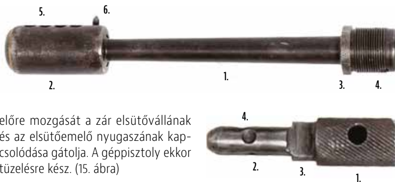
9. ÁBRA. A zárfogantyú részei: 1. zárfogantyú, 2. zármozgatócsap, 3. lapoltnyak/biztosító, 4. rögzítőfészek
