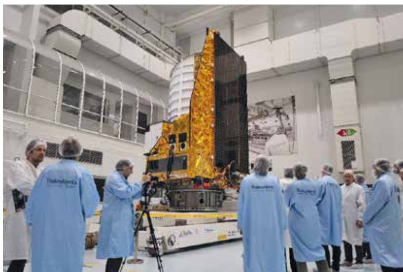
5. ÁBRA. A fény a 4,7 m magas Euclid űrtávcső főtükréből két különböző detektorba jut, majd a berendezés fényképeket készít, továbbá fotometriai és spektroszkópiai méréseket végez [15]
