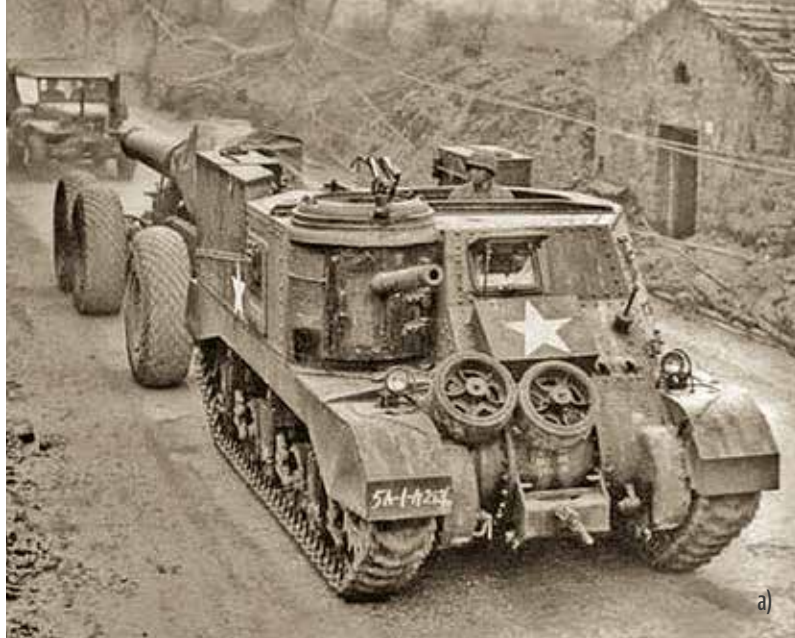
2. ÁBRA. Az M33 Prime Mover 240 mm-es löveget vontat. Olaszország, 1944 a) [3], M31 ARV (más néven M31 TRV) páncélozott mentőjármű a tel-avivi Batey ha-Osef Múzeumban kiállítva b) [4]
