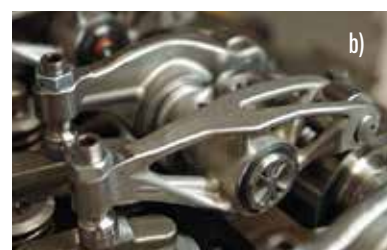
6. ÁBRA. Renault DTI 5 motor eredeti szelephimbája a) és a 3D-s nyomtatott szelephimba b) [11]
