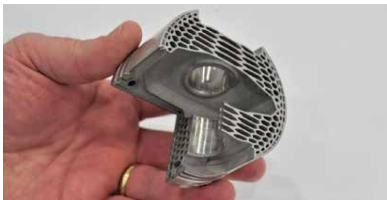
3. ÁBRA. 3D-s fémmnyomatott dugattyú metszete. A könnyített szerkezet mintegy 25%-kal csökkenti a szerkezeti elem tömegét [3]
