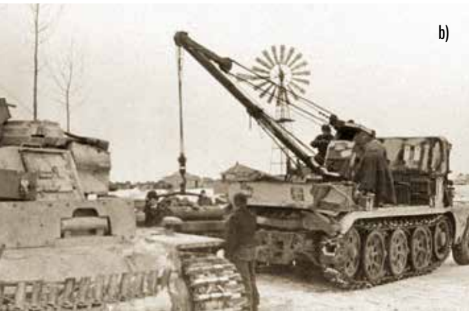
4. ÁBRA. Sd.Kfz 9 „Famo” 18 tonnás féllánctalpas vontató, Donington kastély, Leicestershire [5]
