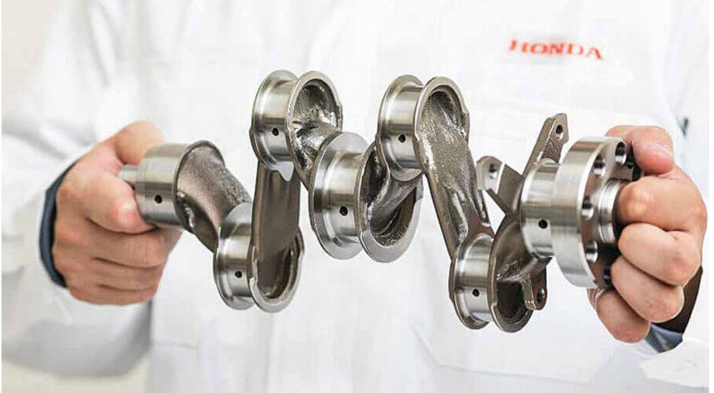
5. ÁBRA. A Honda és az Autodesk közös projektjében tervezett és 3D-s nyomtatott forgattyústengely [8]
