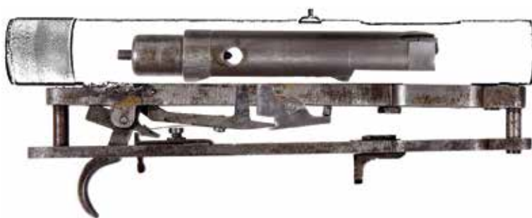
17. ÁBRA. A géppisztoly elsütőszerkezetének és alkatrészeinek helyzete sorozatlövéskor (A szerző szerkesztése a HTM, Modern Lőfegyver Gyűjtemény [Itsz.: 0009/Pu] tárgyának részletéről, Szikits Péter által készített fotó felhasználásával)
