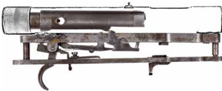
16. ÁBRA. A géppisztoly elsütőszerkezetének és alkatrészeinek helyzete egyeslövéskor (A szerző szerkesztése a HTM, Modern Lőfegyver Gyűjtemény [Itsz.: 0009/Pu] tárgyának részletéről, Szikits Péter által készített fotó felhasználásával)
