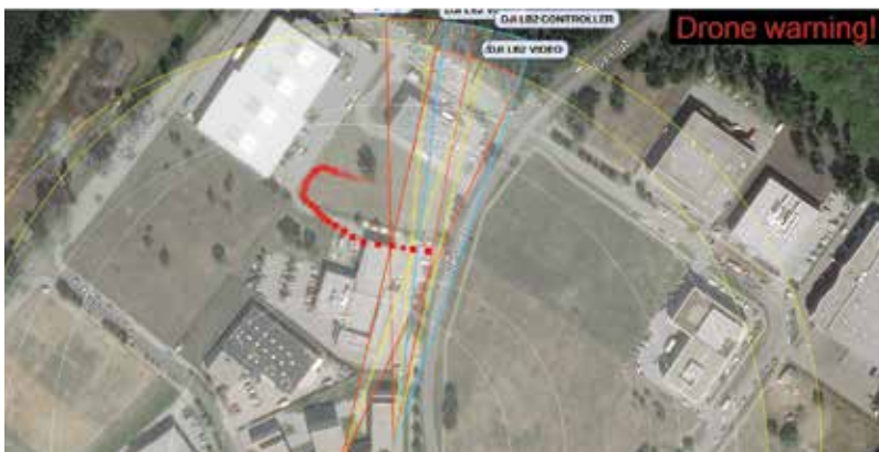
4. ÁBRA. A BXDD10 RF detektor képernyője, iránykeresési eredményekkel (A szerzők felvétele)
