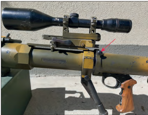
26. ábra. A válltámaszt a tokhoz rögzítő rugós szeg (az ábrán piros nyíl jelölve), a már többször átalakított kísérleti minta múzeumi példányán. A hátsó láb már a legutolsó átalakításból származik (Fotó: Szőke Krisztián)
