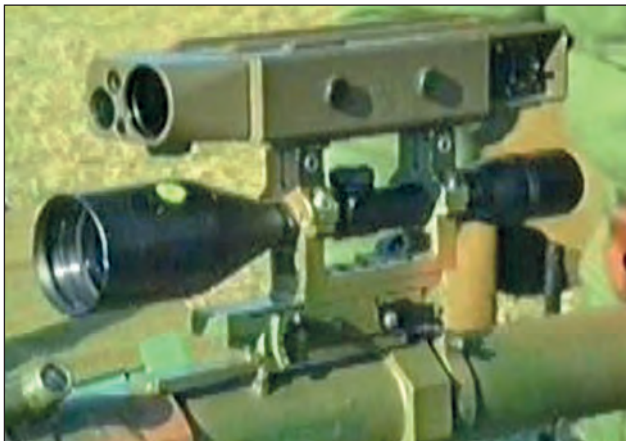
24. ábra. Az új típusú irányzéktartó, helyszög- (lőtávolság) állító dobbal és HECTEC Teleranger B távmérővel
