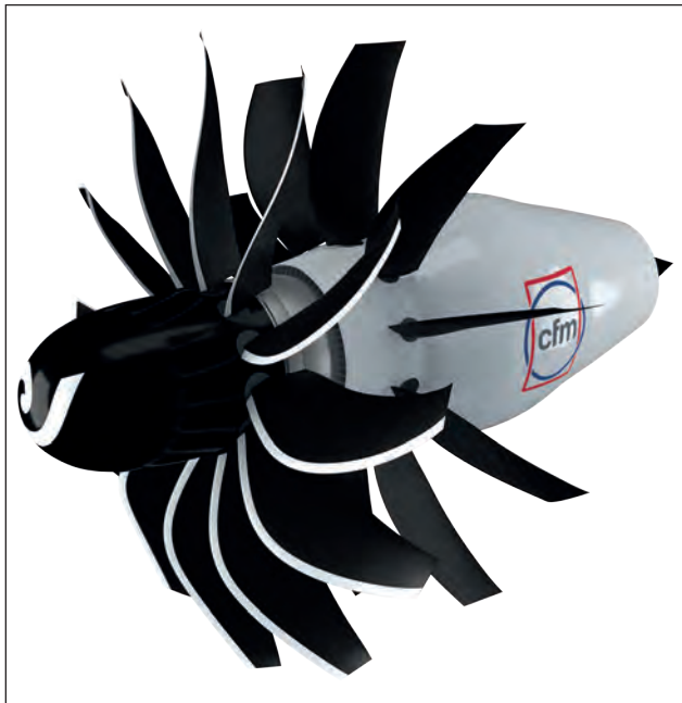
43. ábra. 2021. június 14-én a CFM – a Safran és a General Electric Aviation vegyesvállalata – bemutatta az Open Rotor koncepció által ihletett RISE (Revolutionary Innovation for Sustainable Engines) programot, amelynek célja a CO 2 -kibocsátás 20%-os csökkentése a jelenlegi hajtóművekhez képest (Fotó: Safran)
