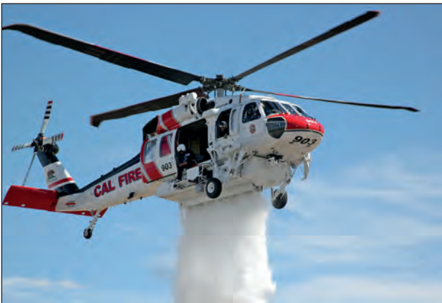
3. ábra. A CAL FIRE S-70i Firehawk helikopterére szerelt külső tartály [19]
