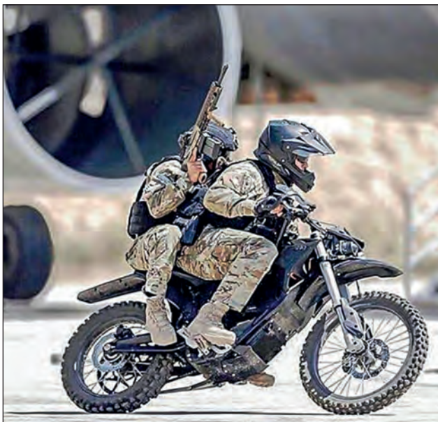
13. ábra. A 34 kW-os (46 LE-s) Zero Motorcycles elektromos katonai terep-motorkerékpár (enduró) két fő szállítására alkalmas [34]
