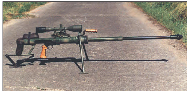
22. ábra. Az átépített Gepárd III. módosított irányzó távcsővel, már homloktámasz nélkül, a távcsővön gumi szemvédővel, és a hátsó lábbal
