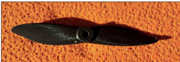
8. ábra. Három réteg folyamatos üvegszál-erősítéssel és vágott szénszál-erősítéssel gyártott UAV-légcsavar (Fotó: Hegedűs Ernő)
