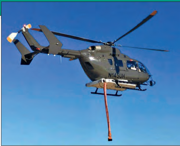
5. ábra. A Simplex Aerospace Model 311 külső hastartályos légi tűzoltórendszer [13]
