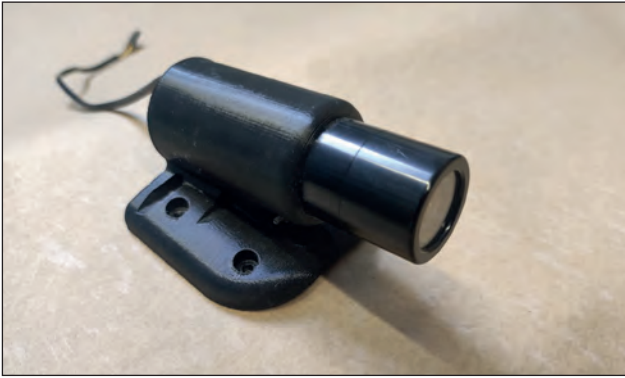
11. ábra. A HM EI Zrt. által gyártott METEOR-3MA gázturbinás, pilóta nélküli célrepülőgép 3D nyomtatott kameratarató konzolja, a kamerával (Forrás: HM EI Zrt.)
