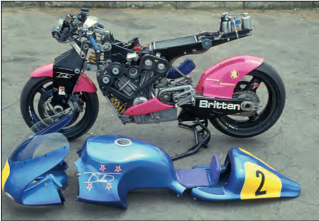
18. ábra. Kompozit Britten V1000 motorkerékpár mindössze 143 kg-os tömeggel. Kevlárból és szénszál-erősítésű műanyagból készült a hátsó lengőkar és az első villa, továbbá a kerekek is [47]
