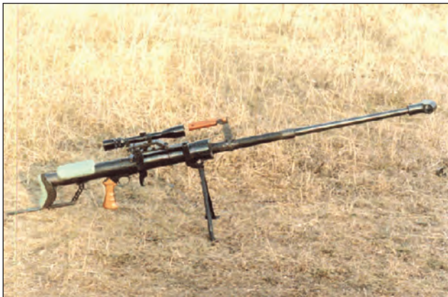
15. ábra. A Gepárd III. jelű kísérleti minta villalábban, kihúzott hónaljpalcával, optikával és már arctámasszal (pofadékkal)
