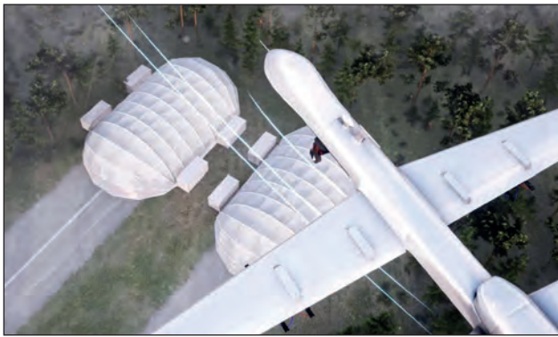
28. ábra. Radarfelderítés elleni belső bélés telepített állapotban [31]
