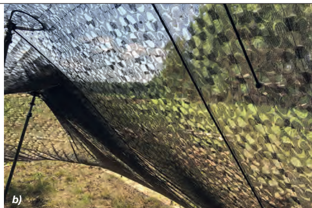
23. ábra. Multispektrális statikus, nyári színezésű 3D-s álcaháló külső a), és belső b) felülete telepített állapotban [27]
