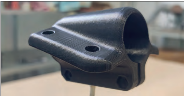
5. ábra. A HM EI Zrt. által gyártott METEOR-3MA gázturbinás, pilóta nélküli célrepülőgép 3D-s nyomtatott kameratartó konzolja (Forrás: HM EI Zrt.)
