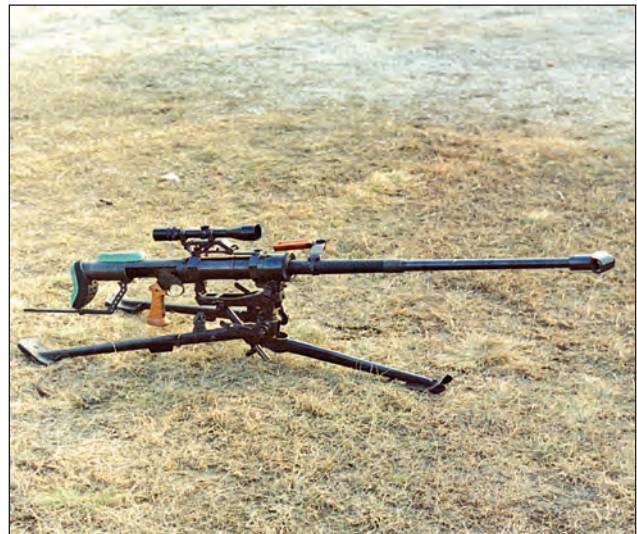
17. ábra. A Gepárd III. jelű kísérleti minta, PKMSz-állványon, kihúzott hónalj pálcával
