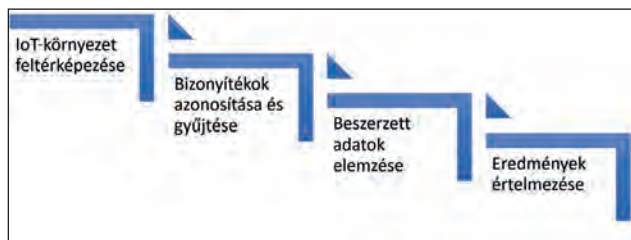
4. ábra. Az IoT forensics folyamat fázisai (A szerző szerkesztése)
