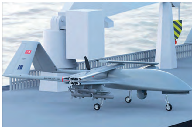
12. ábra. A TB3-as típus felhajtható szárnyakat kapott; a TB2-eshez képest nagyobb méretű eszköz [46]
