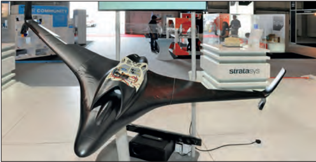
4. ábra. Az Aurora Flight Sciences gázturbinás UAV szerkezetének 80%-át 3D-s nyomtatással állították elő [26]
