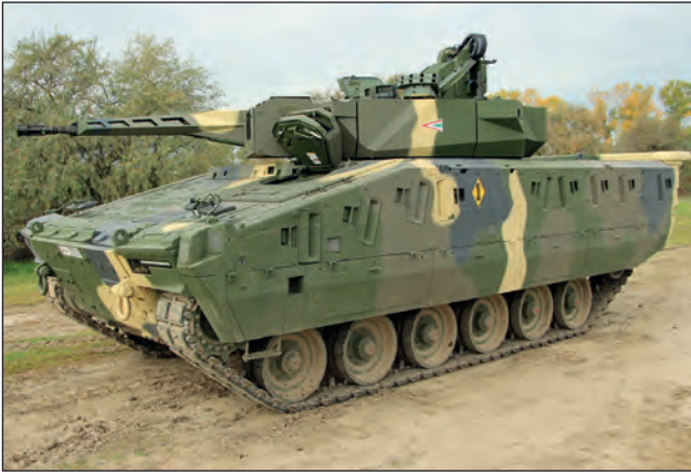
6. ábra. Oldalnézetben jól láthatók a páncéltesten végigfutó StrikeShield aktív védelmi rendszer moduljai
