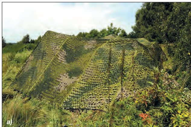
23. ábra. Multispektrális statikus, nyári színezésű 3D-s álcaháló külső a), és belső b) felülete telepített állapotban [27]
