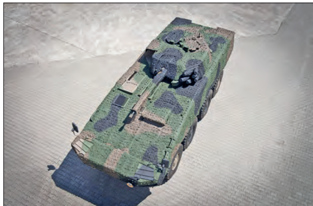
24. ábra. Multispektrális mobil álcázókészlet telepített állapotban [29]
