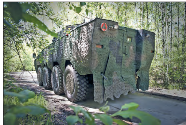
25. ábra. Multispektrális mobil álcázókészlet adott harcjárműhöz igazítva [29]
