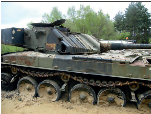
10. ábra. Egy, a Cobham páncéljától megfosztott, brit Challenger 1 harckocsi, amelynek tornyán jól látszanak a jellegzetes páncélzat bekötési, hegesztési pontjai [21]
