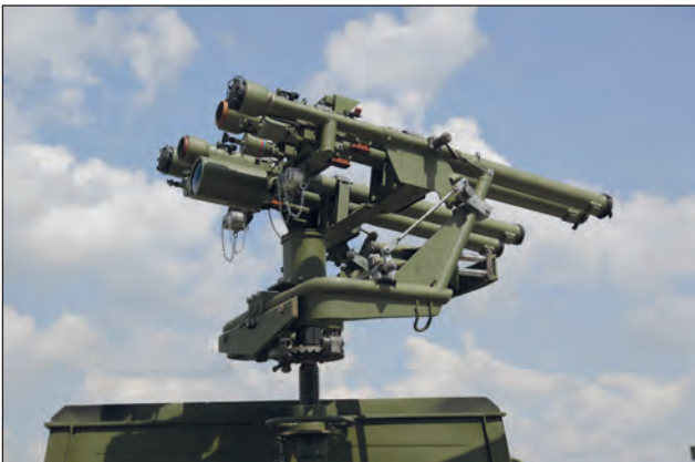
17. ábra. A Mistral rendszer ATLAS indítóállványára integrált, kis hatótávolságú orosz légvédelmi rakéták (Fotó: Kelecsényi István)
