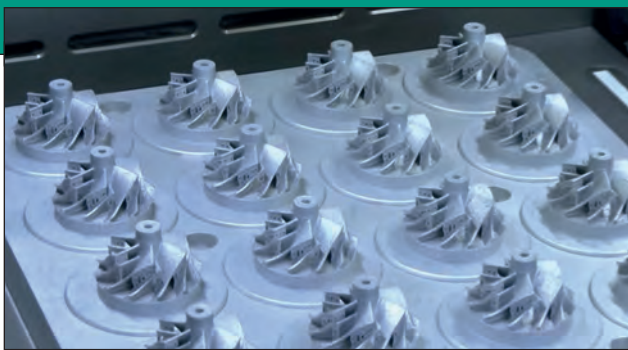
20. ábra. Az alkatrészeket általában huzalszikkra forgácsológéppel ajánlott eltávolítani az alaplapról [24]
