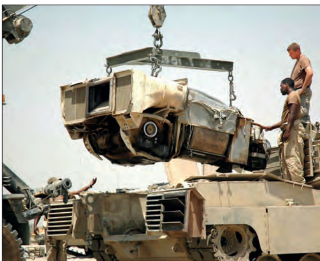
13. ábra. Az Avco Lycoming AGT-1500-as gázturbina és Allison X1100-3B hidrodinamikus nyomatékváltóból álló ún. power-pack cseréje tábori körülmények között, egy amerikai M1A2 típusú harckocsiban [22]
