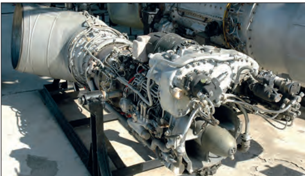
24. ábra. Az Izotov TV2-117A, az első, szovjet szakemberek által helikopterbe tervezett hajtómű (A szerző saját felvétele)
