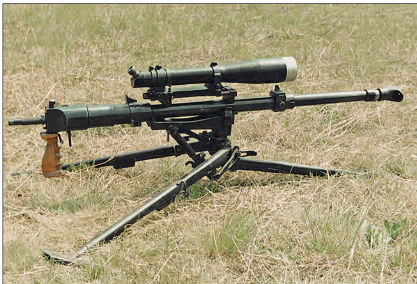
3. ábra. Az átalakított mérőcső – a fejlesztés az előkísérleti mintapéldányaként (ún. deszkamodellként) – egy PKMSz tripodon. Az eszközt egy amortizált tartóba szerelt, 52-szeres (MOM) célfigyelő távcső, ergonomiailag megfelelő kialakítású markolat, és az Egerszegi-féle csőszájfék egészíti ki
