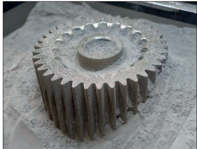
19. ábra. Az elkészült porágys 3D-s fémnyomtatott alkatrésztől el kell távolítani a port [24]
