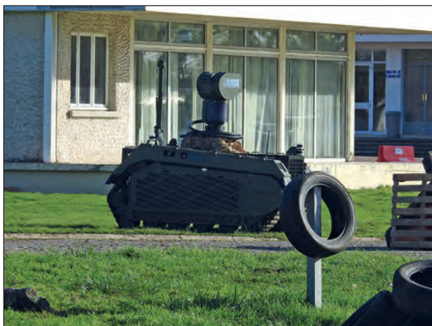
4. ábra. Egy spanyol felderítőkészlettel ellátott THeMIS UGV, felderítő tevékenység közben (Fotó: Ocskay István)
