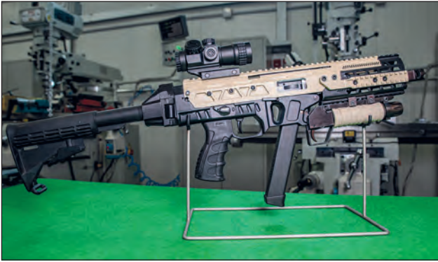
2. ábra. 9 mm-es G9SMG géppisztoly Picatinny-sínre szerelt diopteris irányzékkal (Fotó: HM Zrínyi Nkft. / Snoj Péter)
