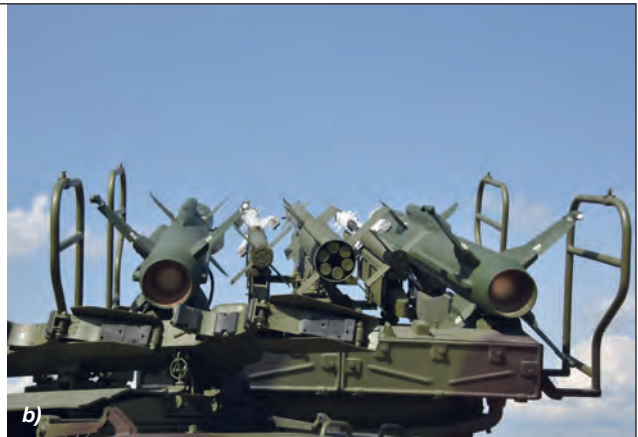
16. ábra. A szerb légvédelem 9K12ML (Kvadrat) rendszerének indítóállványa szemből a), és hátulról b). A modernizált Kub SzPU (TELAR) indítóállvány esetében a középső rakéta helyére három darab R-60 vagy R-73 típusú infravörös, hőkövető rakétaindítót szereltek, ezzel csökkentve a veszélyt, hogy az egycsatornás légvédelmi rendszer másik támadási irányból védtelen maradjon. A hőkövető rakétákhoz nem szükséges a komplexum célravezető lokátorának használata (Fotók: Kelecsényi István)
