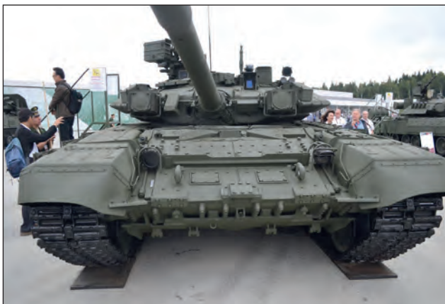
12. ábra. Az Army 2018 kiállításon bemutatott T-90A harckocsi Sthora1 sugárvetőkkel felszerelt aktív védelmi rendszerrel (Fotó: Ocskay István)
