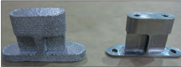
23. ábra. Nyomatott, és a nyomtatás után megmunkált alkatrész [29]
