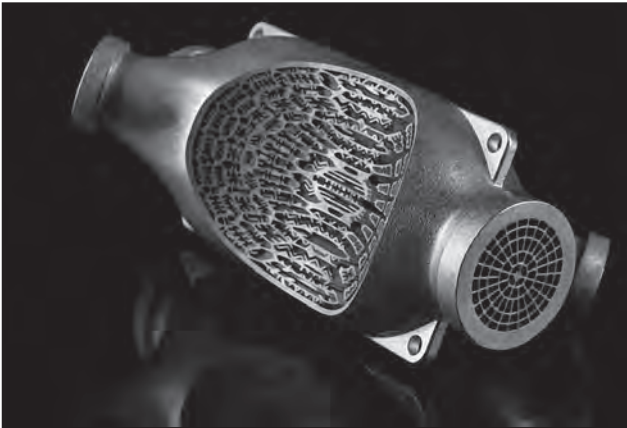
1. ábra. Összetett geometriájú 3D-s fémmnyomtatott hőcserélő [8]
