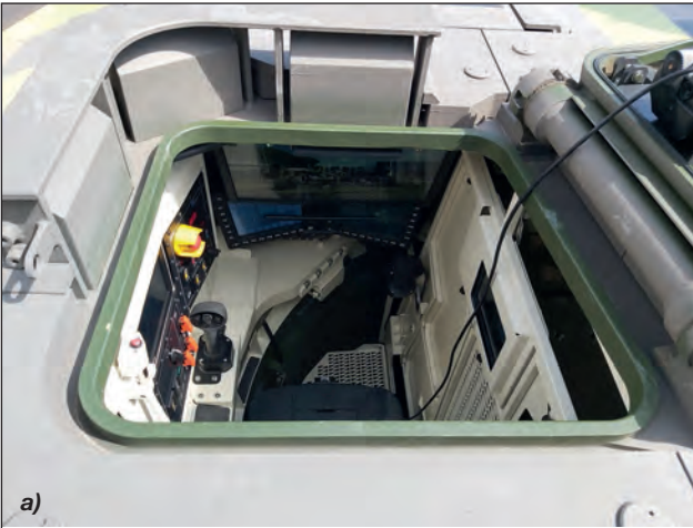
8. ábra. Bepillantás a harckocsiparancsnok a) és az irányzó b) munkahelyére (A szerző felvétele)
