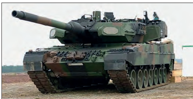
5. ábra. A Leopard 2A7V harckocsi felszerelt Trophy APS védelmi rendszerrel, 2021-ben [21]
