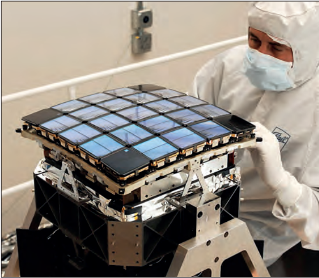
5. ábra. A Kepler teleszkóp görbült fókuszsíkra illeszkedő felületi kialakítású, 42 CCD-ből álló kamerarendszere. A 21 db négyzet mindegyike 2-2 db, szorosan összeillesztett CCD-t tartalmaz, a négy sarokban látható fekete négyzetek pedig 1-1 db, a pontos iránytartást szolgáló (Fine Guide Sensors) érzékelőt tartalmaznak [2]
