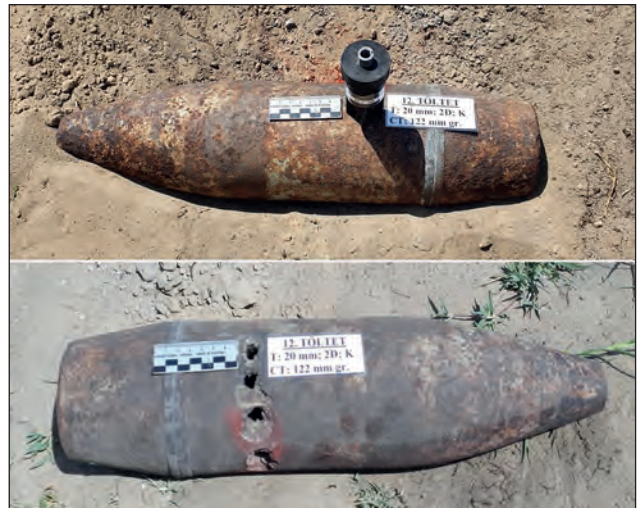
5. ábra. A 122 mm-es szovjet gyakorló tüzérségi gránatra helyezett kumulatív töltet (fent) és a robbantás után keletkezett lyukak (lent) (A szerző szerkesztése)
