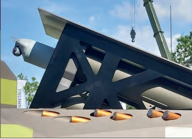
7. ábra. A bal oldali lőszertárolóba integrált HERO-120 négyes indítókonténer, előtte a ROSY kódgránátvetők vetőcsövei (A szerző felvétele)
