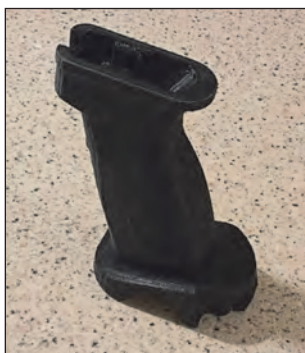
4. ábra. 3D-s műanyag nyomtatással előállított fegyvermarkolat (Fotó: Dr. Hennel Sándor)
