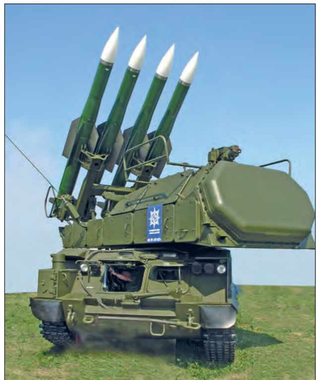
21. ábra. A Buk rendszer indítójárművei nemcsak önálló tűzvezetésre képesek, de más egységeknek is tudnak célinformációkat adni [63]
