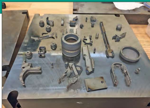
5. ábra. 3D-s fémnyomtatással előállított gránátvető alkatrészei [4]
