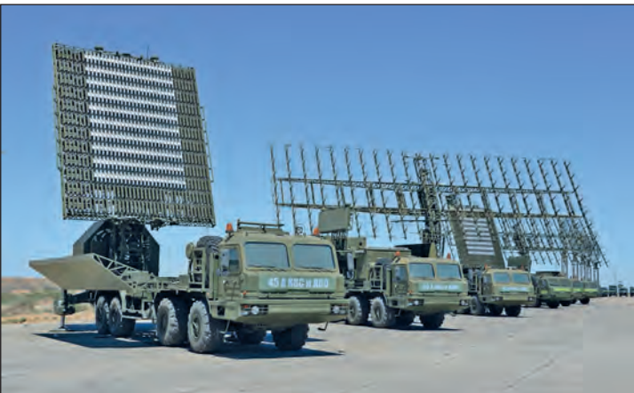
19. ábra. Az 55ZS6M radarkomplexum RLM-D deciméteres hullámhosszú (elől) és RLM-M méteres hullámhosszú (hátsó) radarmoduljai. A Nebo-M integrált, többfunkciós, többsávú, többszörösen programozható radarrendszer, amely nagy hatékonysággal képes felderíteni az alacsony észlelhetőségű, 5. generációs repülőgépeket, és érzékeli a nagy hatótávolságú ballisztikus rakéták kilövéseit is [55]
