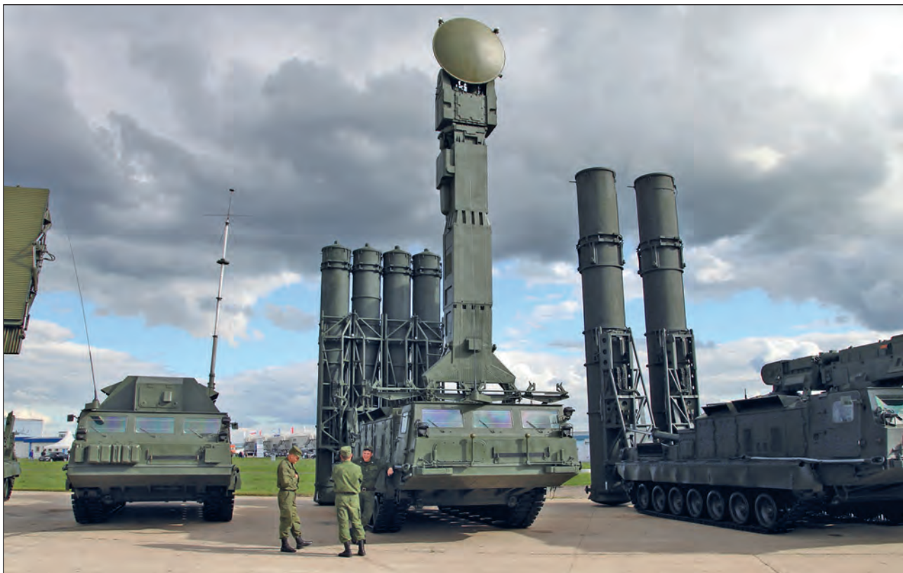
23. ábra. A szárazföldi erők által hadszíntéri rakétavédelemre alkalmazott Sz-300V4 rendszer elemei. Jól látható az indítójármű saját, árbócra szerelt radarja [68]
