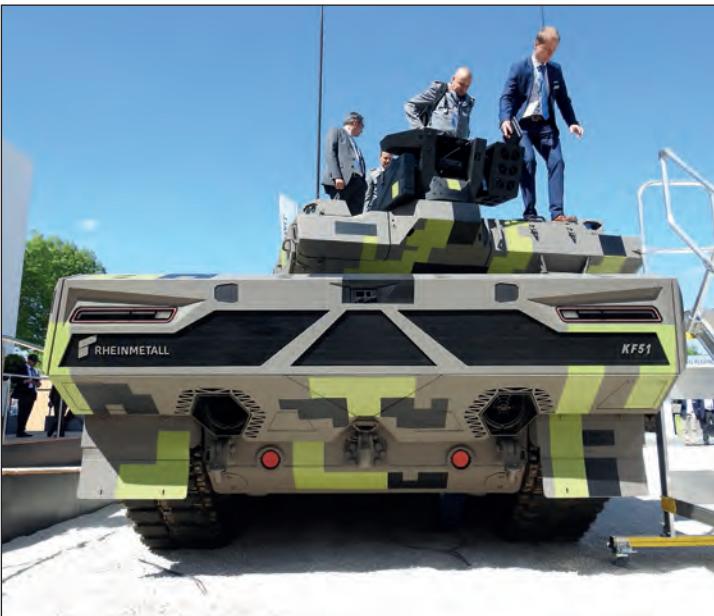
4. ábra. A KF51 Panther alapharckocsi farpáncélja az eredeti Leopard 2A4 páncéltestéhez képest apróbb módosításokkal, dizájnelemekkel (A szerző felvétele)
