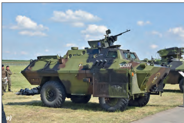
7. ábra. BOV M-86 kerekes harcjármű a) és az Ejder Yalçin török MRAP járművekhez hasonló, szerb gyártású BOV M16 Miloš b) (Fotók: Kelecsényi István és Gazsó Krisztián Árpád)
