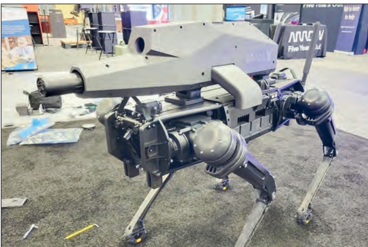
47. ábra. Példa felfegyverzett robotkutyára: különleges felhasználású, kezelő nélküli fegyver (SPUR – Special Purpose Unmanned Rifle) [169]
