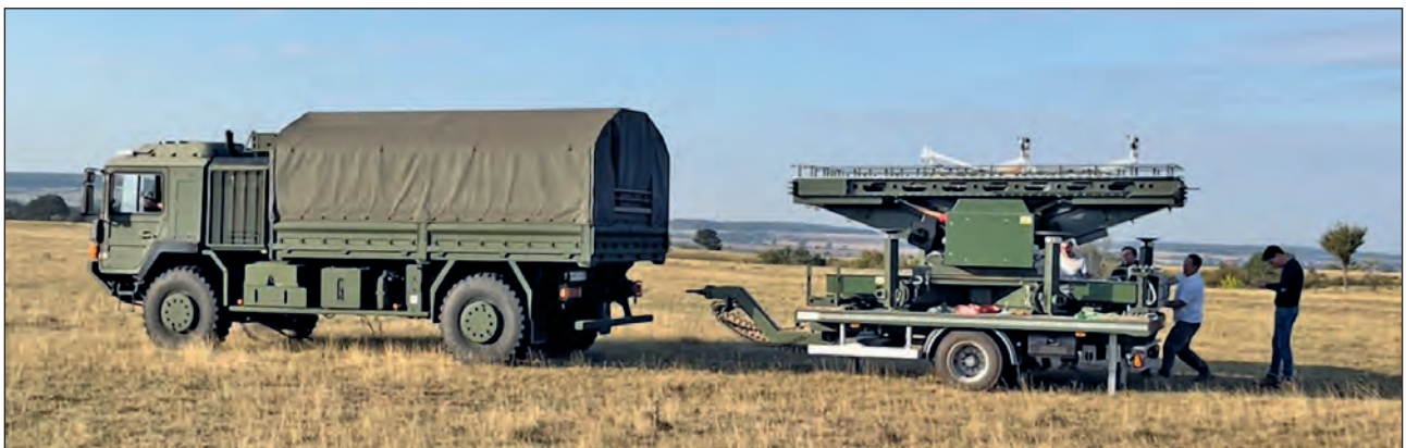
47. ábra. A katapult szállításra előkészítve (Fotó: Nagy Attila)
