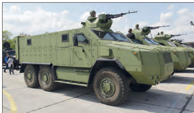
8. ábra. A Zastava Tervo által gyártott 6 × 6 kerékképletű M-20 MRAP szállítójármű, 12,7 mm-es géppuskával (Fotó: Gazsó Krisztián Árpád)
