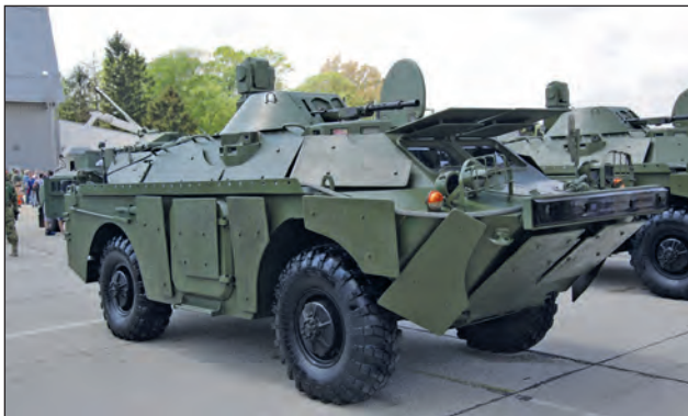
4. ábra. Orosz relációból származó szerb BRDM-2MSz kerek felderítő harcjárművek, amelyeket – az alapváltozat- hoz képest – kiegészítő páncélatzattal és modernizált optikai eszközökkel szereltek fel (Fotó: Kelecsényi István)
