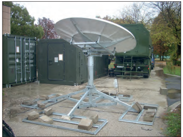
3. ábra. A HIK-konténer VSAT műholdas antennája (A szerzők felvétele)
