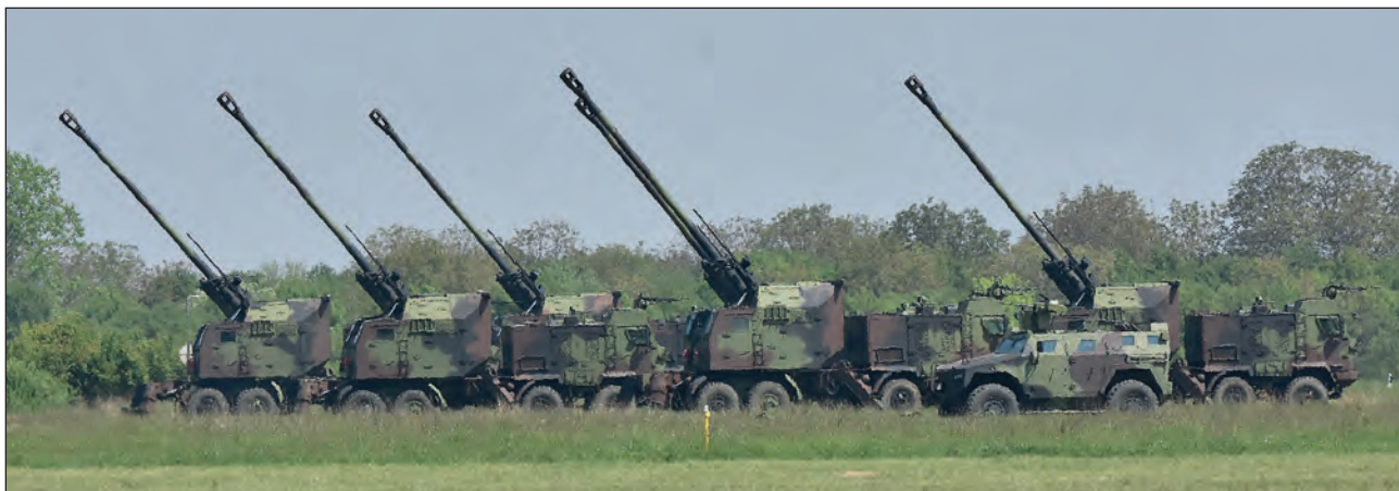
10. ábra. Szerb gyártású M84 B-52K NORA önjáró lövegek a dinamikus bemutatón (Fotó: Kelecsényi István)
