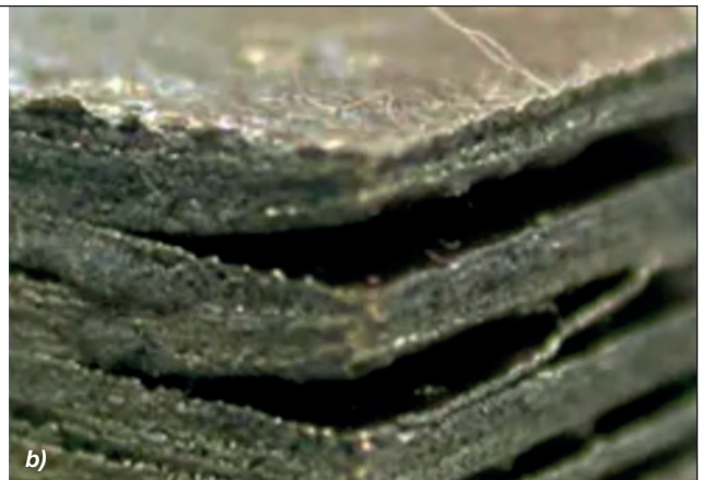
18. ábra. Nem megfelelő nyomtatási paraméterbeállításokat alkalmazva, porágyas eljárásnál a nagy belső feszültségek okozta stressz hatására az alkatrészek megrepedtek a), illetve delamináció (rétegenkénti szétválás) keletkezhet b) [16]
