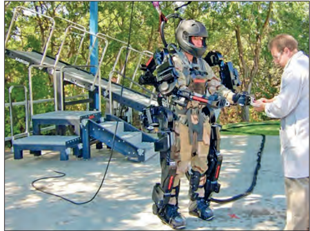
43. ábra. A XOS2 exoskeleton [161]
