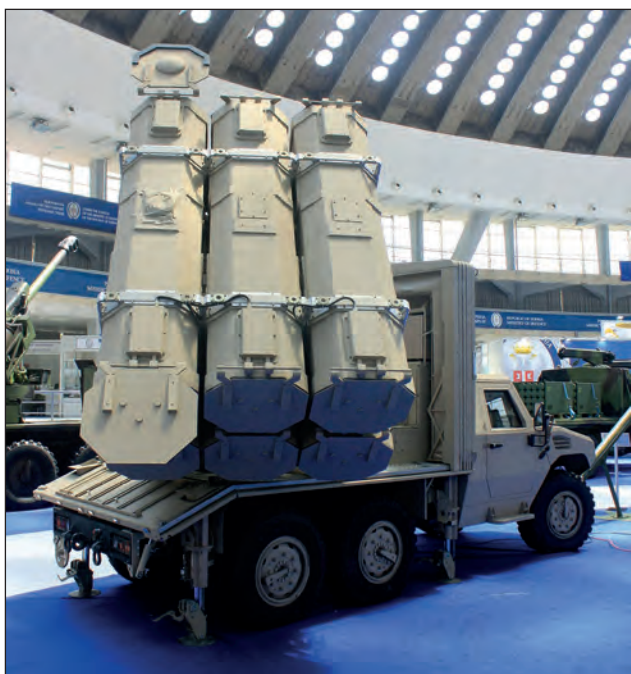
13. ábra. ALAS irányított rakétarendszer a Nimr jármű alvázán a „Partner 2017” fegyver- és haditechnikai kiállításon (Forrás: Srđan Popović, Wikimedia Commons)
