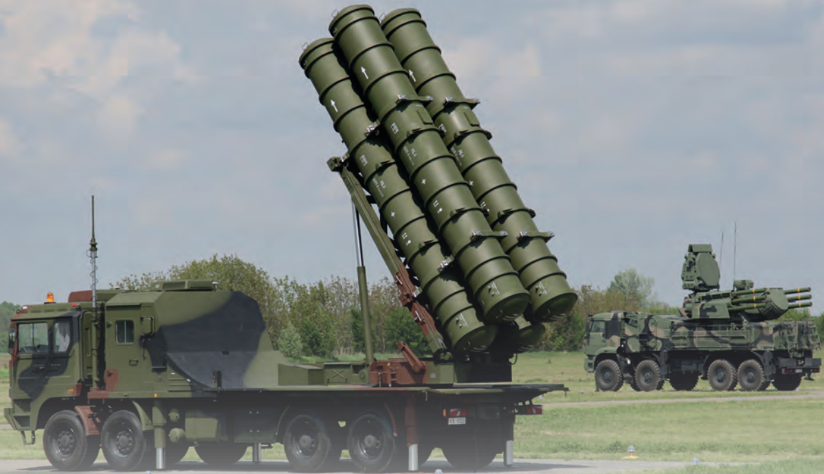
1. ábra. A kínai HQ-22 közepes hatótávolságú légvédelmi rakétarendszert egy Pancir komplexum oltalmazza a batajncai légbázison (Fotó: Kelecsényi István)
