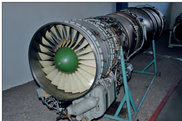
9. ábra. A Tumanszkij R-11 a Szovjetunióban, az 1950-es évek elején a Szergej Tumanszkij ® vezette OKB-300 tervezőirodában kifejlesztett gázturbinás sugárhajtómű volt, amelyet főként a MiG-21 vadászrepülőgép változatainál alkalmaztak [4]
