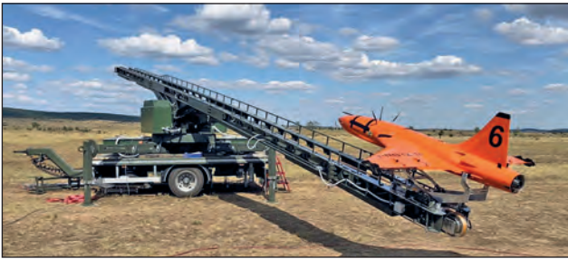
39. ábra. Katapulton a Protar. Felszállásra előkészítve, üzem közben (Fotó: Nagy Attila)
