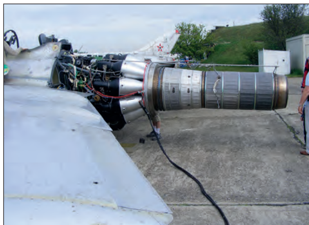
8. ábra. A 031-es oldalszámú MiG-15 típusú, első generációs sugárhajtású vadászrepülőgép VK-1-es hajtóműve a tököli repülőtéren 2021-ben (Fotó: a szerző saját felvétele)
