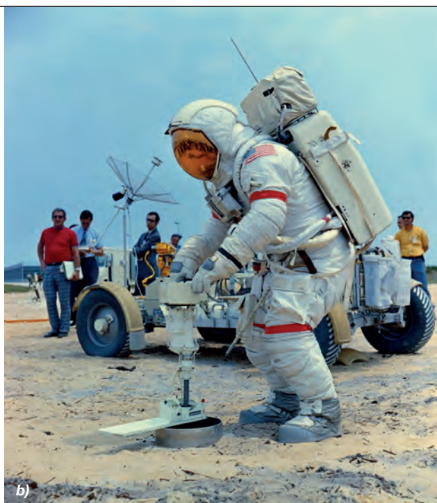
7. ábra. Az Apollo-12 asztronautája kalapáccsal üti a Hold talajába a mélymintavevő csövet a). Elektromos fúró tesztelése a Földön b) [15] [16]
