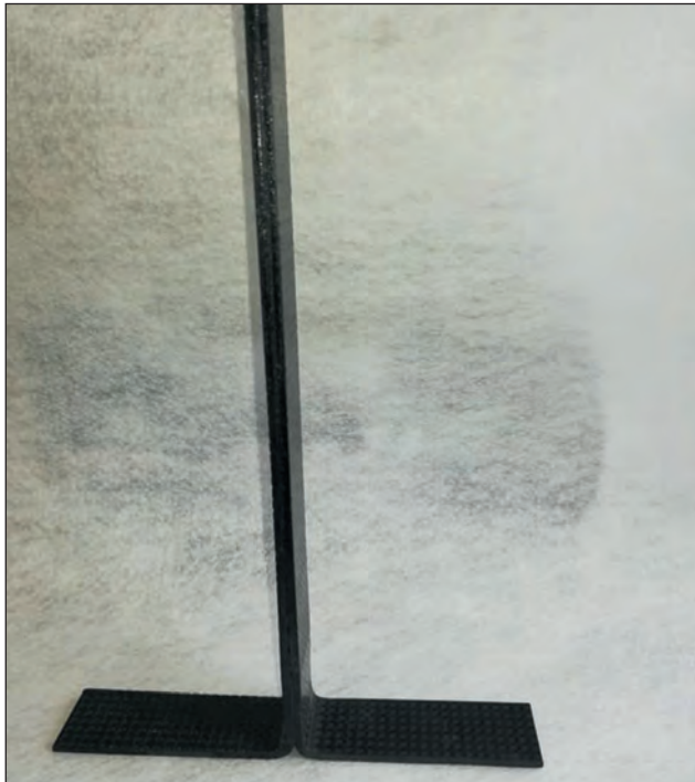
25. ábra. Lefejtő vizsgálatra előkészített laminátumok vizsgálati mintatestje (Fotó: Dr. Farkas Csaba)
