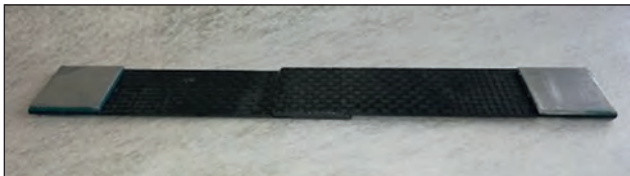
24. ábra. Átlapolt laminátumok vizsgálati mintatestje (Fotó: Dr. Farkas Csaba)
