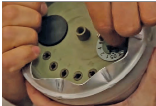
26. ábra. Az aknazetttében elhelyezkedő akna önhatástalanítási idejének beállítása [18]
