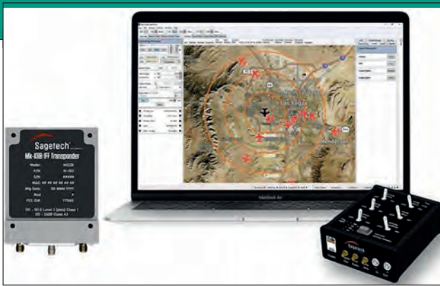
1. ábra. Sagatech Mk-XIIB Mode 5 képes transzponder (balra), kezelői szoftver grafikus felhasználói felülettel és teszteszköz (jobbra) [10] (Sagatech Avionics engedélyével)
