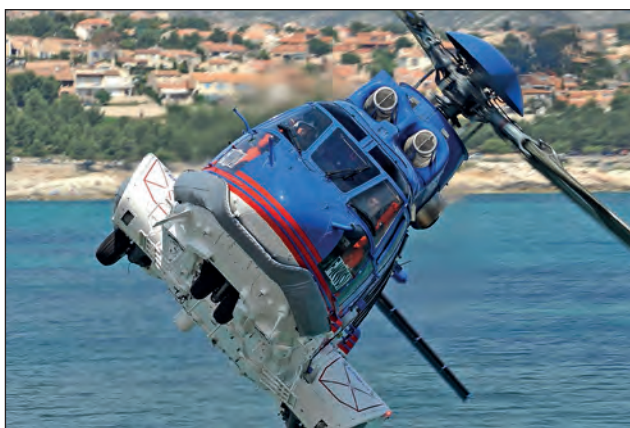
5. ábra. A törzsbe és a félszárnyakba félig behúzott orr- és főfutók csökkentik a légellenállást (Forrás: Airbus / az Airbus Helicopters engedélyével)
