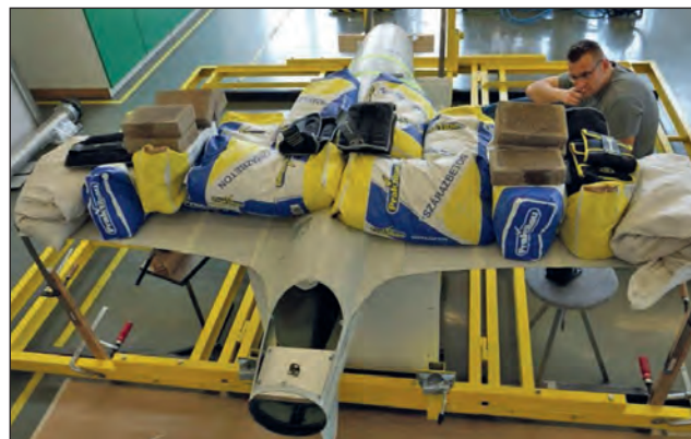
30. ábra. A Protar szárnyhajtás szilárdsági vizsgálata (Fotó: Dr. Farkas Csaba)
