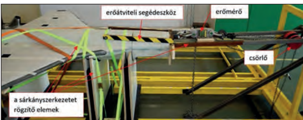
34. ábra. Protar-katapult. Az indítóberendezés bekötési pontjainak szilárdsági vizsgálata (Dr. Farkas Csaba felvétele és szerkesztése)
