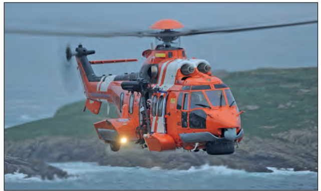
3. ábra. Kutató-mentő feladatokra kialakított H225 típusú helikopter jobb oldali ajtaja felett jól látható a mentési célokat szolgáló csörlő (Forrás: Airbus / az Airbus Helicopters engedélyével)
