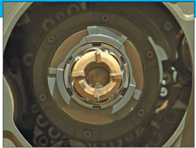
20. ábra. A Perseverance fúrófej, és mintavételi cső [38]
