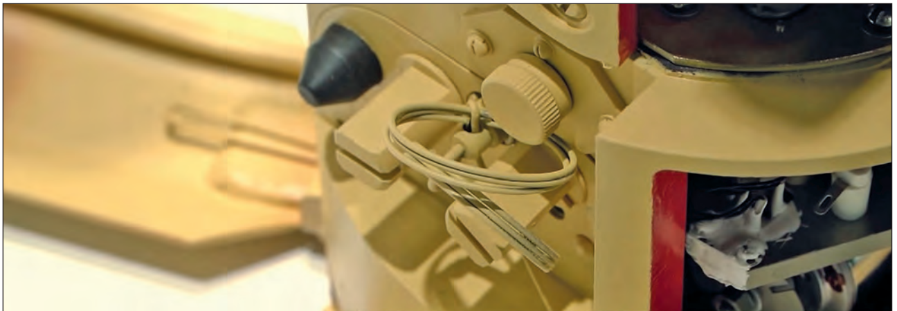
31. ábra. Az aknatest oldalán található biztosítószege (A szerző szerkesztése a [24] alapján)
