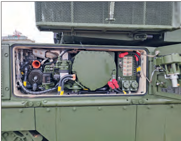
7. ábra. A Leopard 2A7HU beépített segédaggregátora a kinyitott szervízajtó mögött. A gondos tervezés következményeként a leggyakoribb karbantartási műveletek elvégezhetőek további bontás nélkül (Fotó: Végvári Zsolt, 2021. Várpalota)
