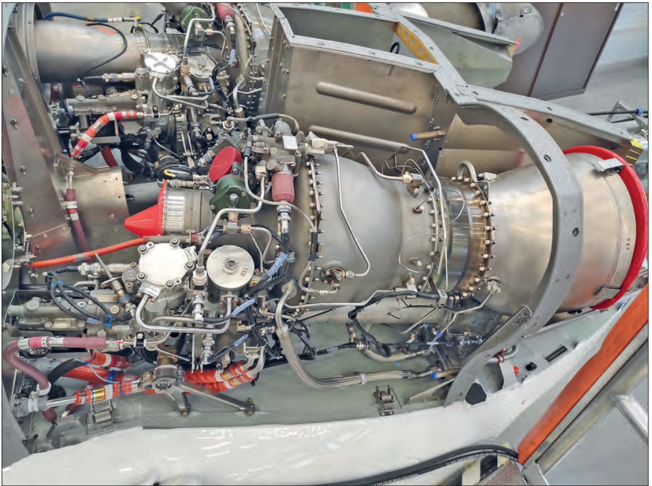
6. ábra. Arriel 2E elhelyezése a hajtóműtérben (Fotó: Varga Béla)
