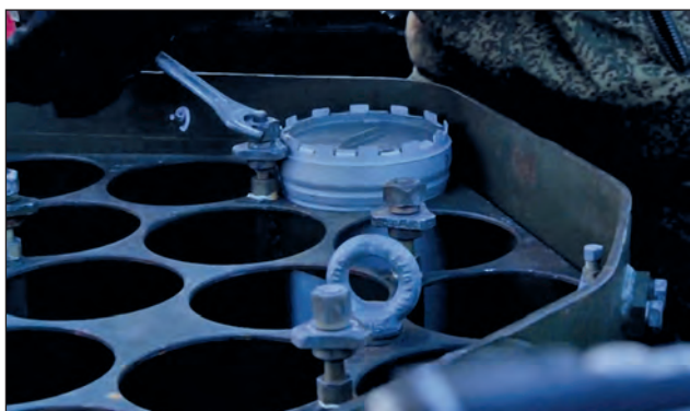
11. ábra. A telepítőkonténerbe helyezett aknakazetta rögzítésének módja [12]
