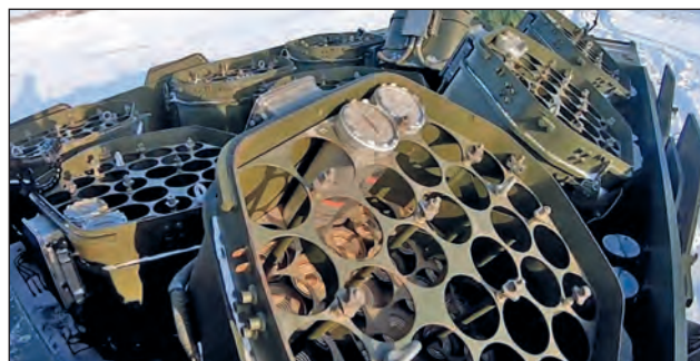
10. ábra. Az aknakazetták elhelyezkedési rendje a telepítőkonténerben [12]
