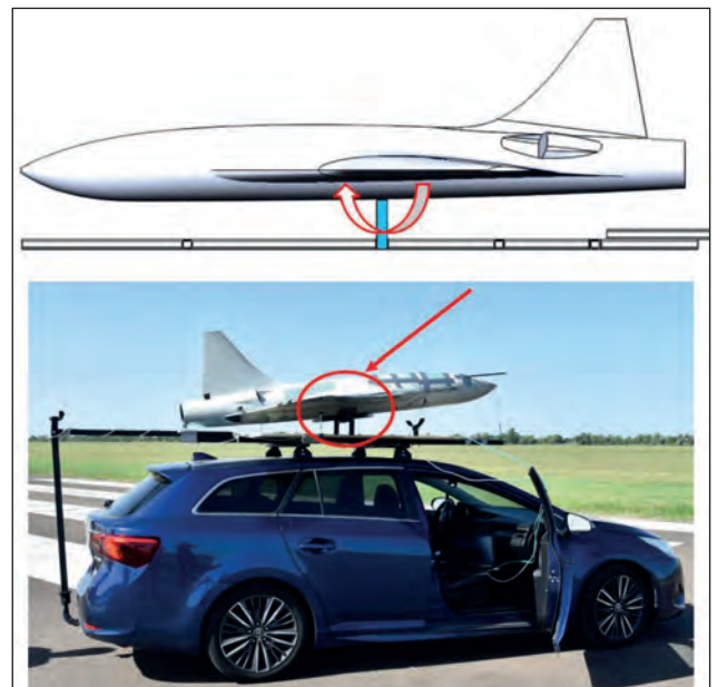
16. ábra. A Protar repülés előtti magassági kormányhatásossági tesztje (A szerzők felvétele és szerkesztése)
