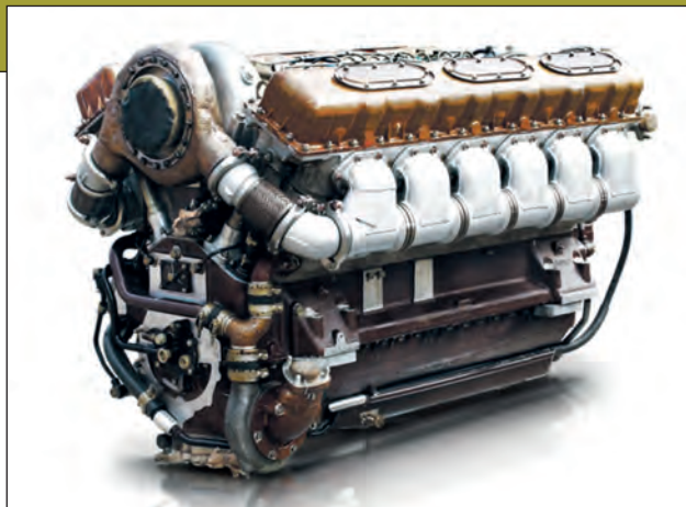
11. ábra. V-92 típusú orosz motorfejlesztés 736 kW (1000 LE) [17]
