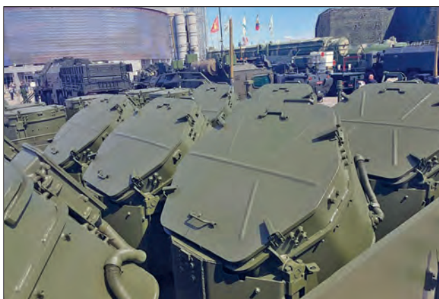
12. ábra. A telepítőkonténerek zárófedéllel fedve, szállítási helyzetben [11]
