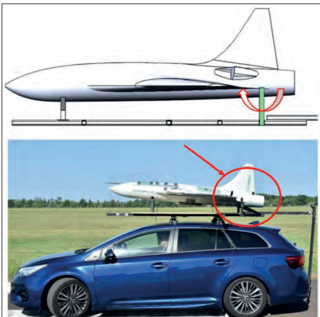
15. ábra. A Protar repülés előtti elemelkedési karakterisztika-tesztje (A szerzők felvétele és szerkesztése)
