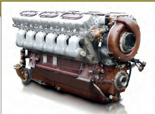
10. ábra. V46-6 típusú 574–618 kW-os (780–840 LE-s) harckocsimotor (WOLA S12U változat) [16]
