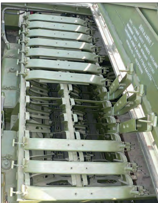
4. ábra. A GMZ-3 egyik aknatároló és -adagoló rekesze nyitott helyzetben [6]
