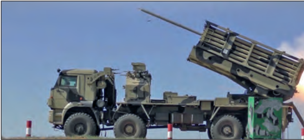
6. ábra. Az ISZDM távknásító jármű, aknatelepítés közben [7]
