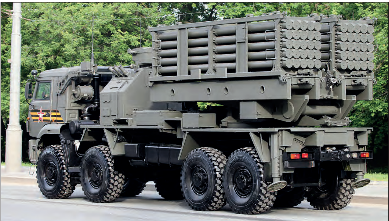
8. ábra. A vetőcsövek elhelyezkedése a konténerekben [9]
