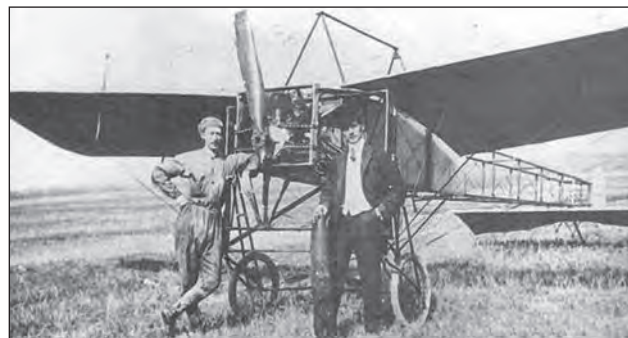
3. ábra. Légsavartörés a Horváth II. gépen. Előtérben Horváth Ernő konstruktőr (jobbról) és Prodam Guido pilóta [6]
