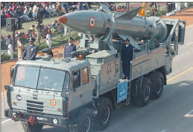
5. ábra. A rövid hatótávolságú Prithvi-I-est nagy terepjáró képességű, cseh gyártmányú Tatra 815-ösökre telepítették [24]
