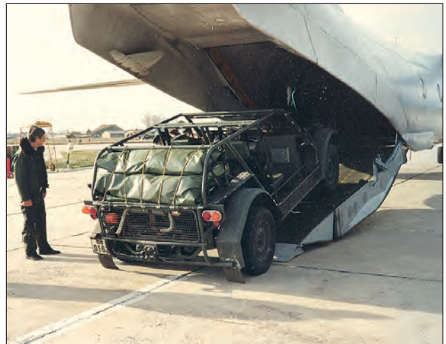
2. ábra. Az 1990-es évek elején a Haditechnikai Intézet (HTI) fejlesztésében megépült „Szöcske” fantáziánévű ultrakönnnyű terepjáró járműveket is úgy tervezték, hogy Antonov AN-26-os repülőgépekkel, illetve Mi-8T és Mi-17 közepes szállítóhelikopterekkel is szállítható legyen. A képen az AN-26-os rámpáján a KTJ egyik prototípusa látható (Fotó: HTI archív)
