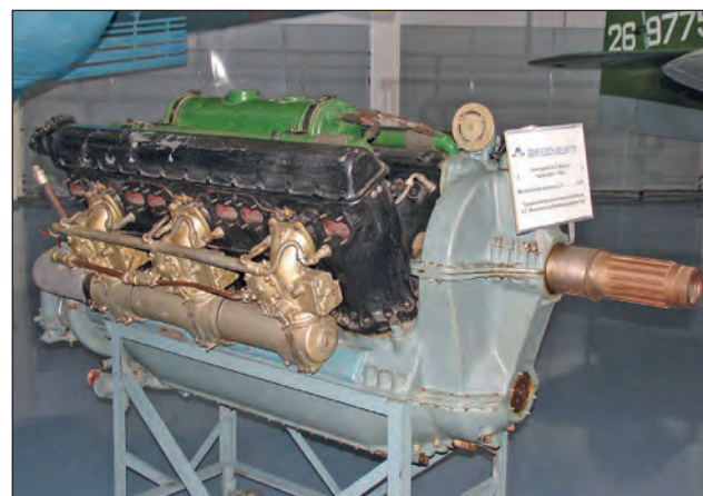
3. ábra. Klimov VK105 típusú repülőmotor (1939) a VK100 továbbfejlesztett változata (Fotó: Pásztor Miklós)
