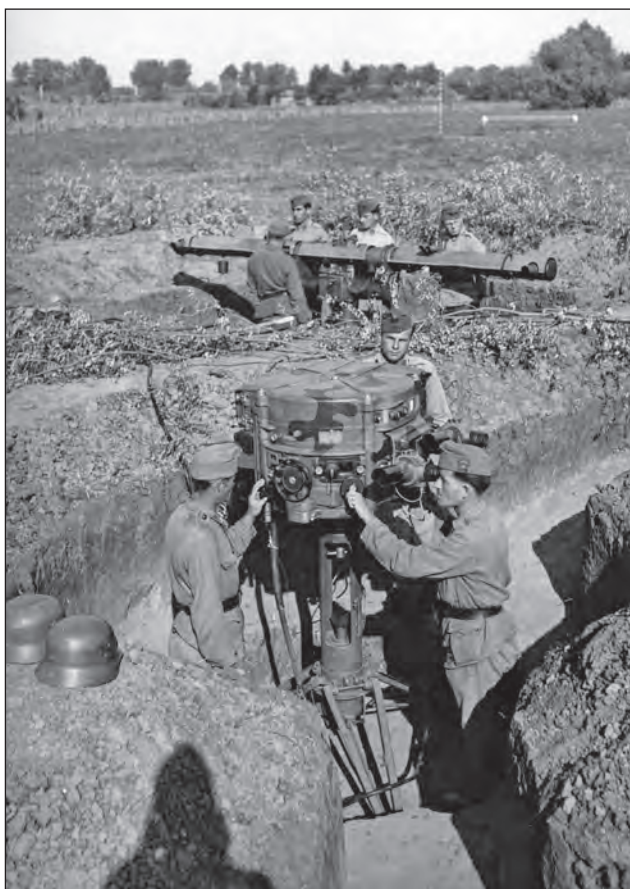
15. ábra. A 34/38M Gamma–Juhász lőelemképzőnek, és a 4 m-es távmérőnek a légvédelmi lövegektől távolabb történő telepítése 1944 novemberében, Szob térségében (Fotó: HM HIM, 94176–39)
