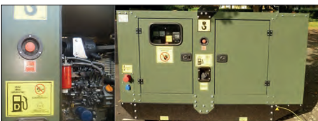
21. ábra. Részlet (bal oldal) és a teljes fotón a Magyar Honvédség egy PRAMAC GCW15 DÜ.ÁF.BKN. 10kW-os, teherautón szállítható, targoncával, daruval emelhető aggregátora (Fotó: Ott István Dániel)
