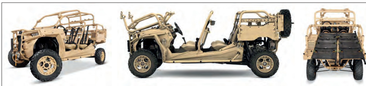
4. ábra. A Polaris MRZR 4 több feladatra alkalmas moduláris felépítésű jármű. A képeken különböző felépítményű változatai láthatók, többek között a sebesültszállító változat hordágytartóval és hordágyakkal [5]
