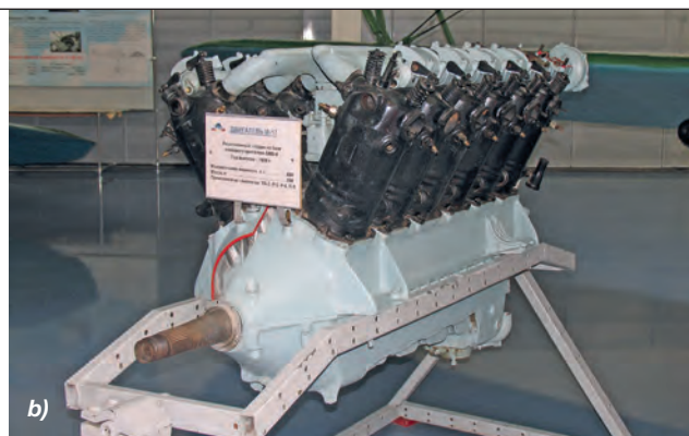
1. ábra. BMW VI. V12 repülőgépmotor a) és Mikulin M17 motor b). A két motor konstrukciós hasonlósága egyértelmű [16]
