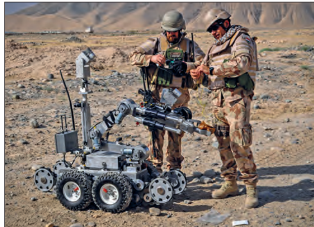
3. ábra. Az ANDROS F-6A típusú, távirányítású nehéz tűzserész robot az afganisztáni műveletekben is segítette a magyar tűzserészek munkáját (Fotó: HM Zrínyi Nonprofit Kft./honvedelem.hu)
