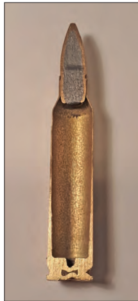
6. ábra. Az 5,56×45 mm-es SS109 normál lőszer felépítésének metszete: hüvely és lövedék (Fotó: Éles Péter)
