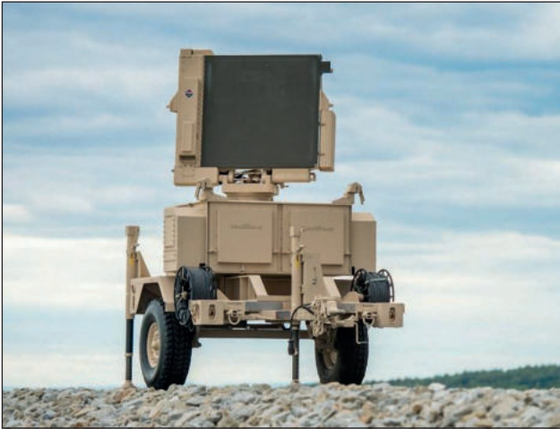
4. ábra. Az AN/MPQ-64F1 Sentinel utánfutóra szerelt változata [7]
