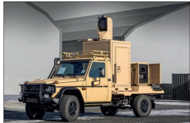
7. ábra. Az elektrooptikai szenzor [7]
