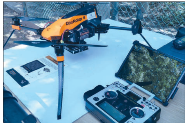
14. ábra. Térképészeti és földmérő feladatokra alkalmas drón (RPAS UAV) – GeoRotor 4 (Forrás: MH GEOSZ)
