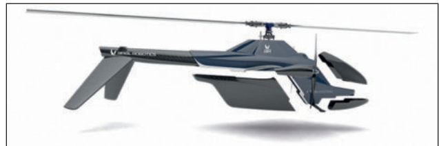
59. ábra. A Gyrotrak GT20 moduláris törzskialakítása [28]
