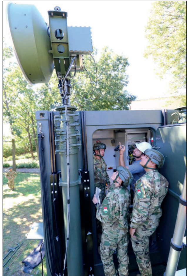
6. ábra. Grócz Olivér fejlesztő-tervező gépészmérnök az árbócok kitolását és az antennaforgatók működését ismerteti (Fotó: Révész Csaba)
