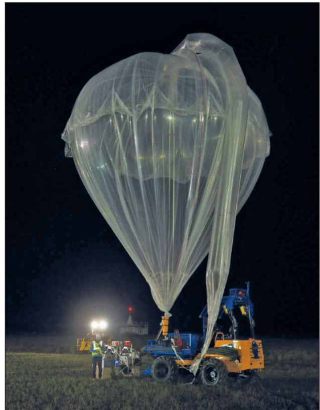
8. ábra. 4G mobiltelefon-átjátszót szállító ballon felszállás előtti ellenőrzése (Forrás: [6] ESDPA)
