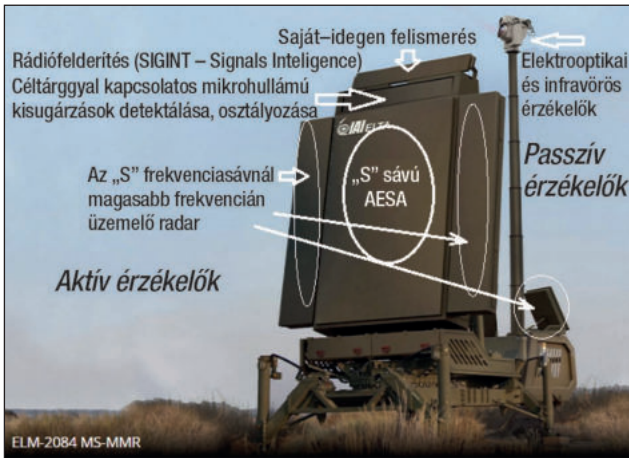
5. ábra. Az ELM-2084 MS-MMR aktív és passzív érzékelői (A szerző szerkesztése a [2] alapján)
