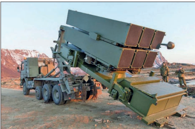
5. ábra. A konténeres indító telepítése [7]
