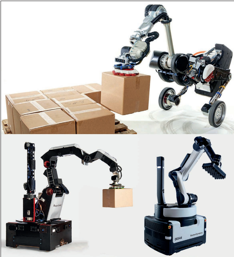
46. ábra. Boston Dynamics logisztikai robotok: fent – Handle; balra lent – Strech prototípus; jobbra lent – Strech kereskedelmi változat [166]
