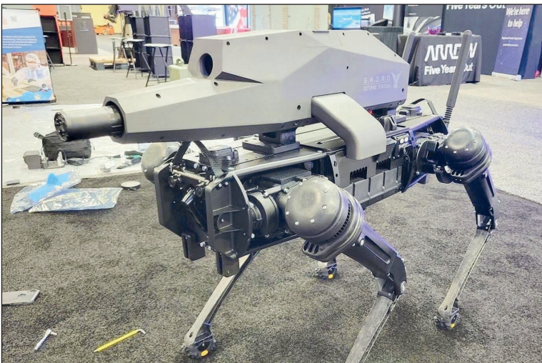
47. ábra. Példa felfegyverzett robotkutyára: különleges felhasználás, kezelő nélküli fegyver (SPUR – Special Purpose Unmanned Rifle) [169]
