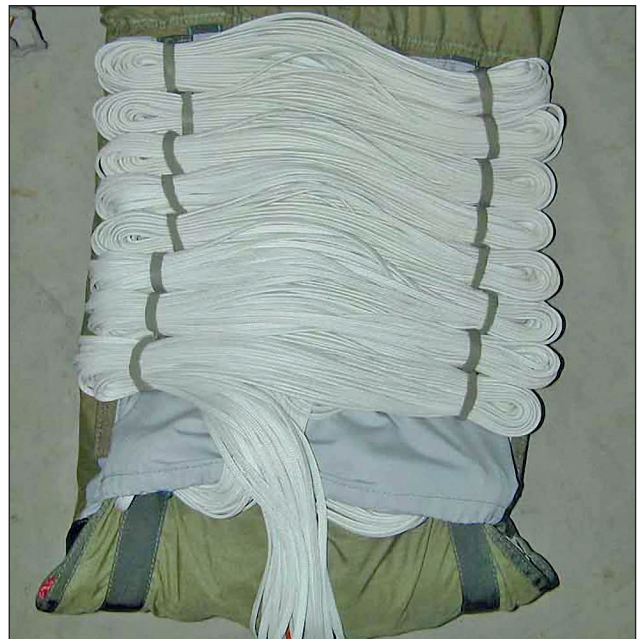
5. ábra. A ZF-2 ejtőernyő hajtogatása – a zsinórzat felfűzése [4; 11. o.]
