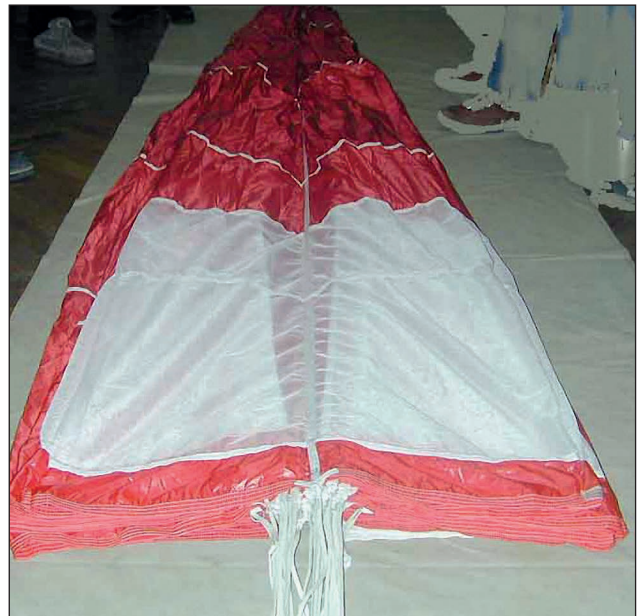
4. ábra. A ZF-2 ejtőernyő hajtogatása – a kupola felszedése [4; 8. o.]
