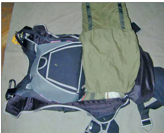
6. ábra. A ZF-2 ejtőernyő hajtogatása – tokra helyezés [4; 12. o.]
