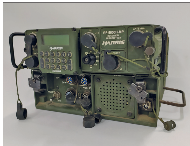
3. ábra. Harris gyártmányú Falcon-II AN/PRC-150 (C) 20 W-os rádióberendezés, és egy RF-5833H 150 W-os járműfedélzeti erősítő (Fotó: Dóczi István)
