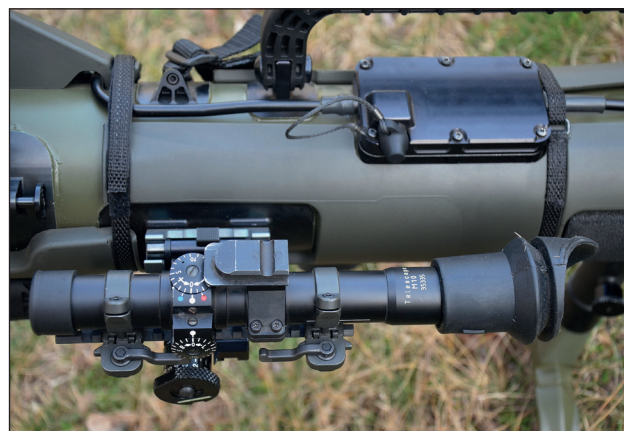
8. ábra. A CGM4 fegyverrendszer háromszoros nagyítású, 557B jelű, elsődleges optikai irányzékkel (Fotó: Birinyi János)
