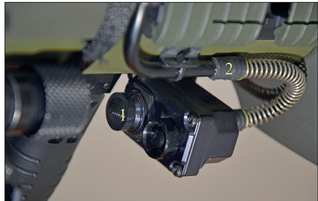
13. ábra. Az Aimpoint FCS13RE irányzék kiegészítő vezérlő-joystickja (1) és a vezérlés vezetéke (2) (Fotó: Birinyi János)
