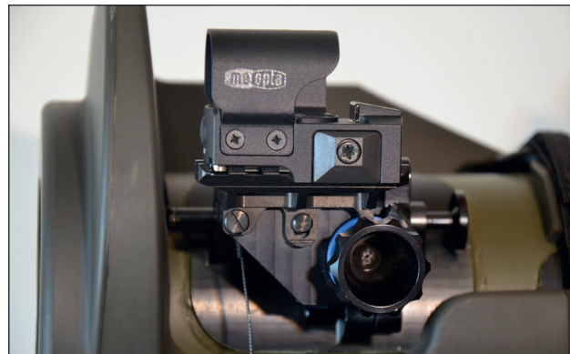
6. ábra. A CGM4 fegyverrendszer vöröspontos (másodlagos) irányzéka (Fotó: Birinyi János)
