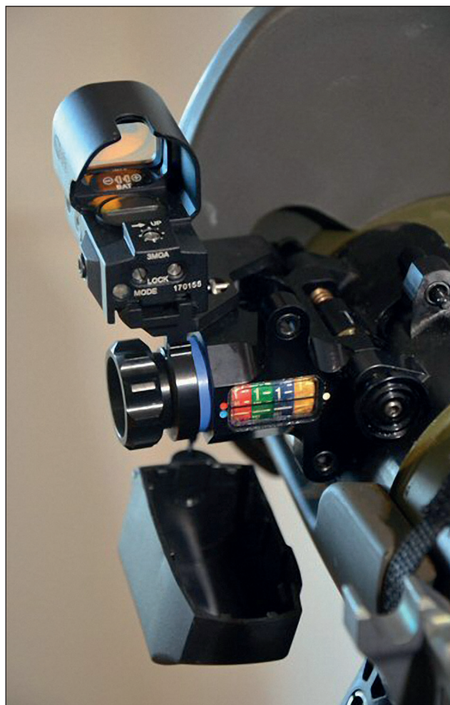
7. ábra. A vöröspontos irányzék és a ballisztikai beállító tárcsái (Fotó: Birinyi János)
