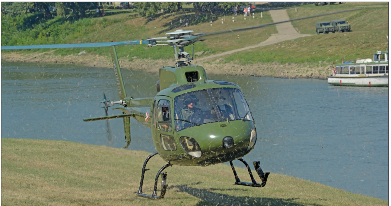
5. ábra. A helikopter kis tömegéhez mért Turbomeca Arriel hajtómű jelentős teljesítményfelesleget biztosít a pilóták manővereihez. A képen dinamikus emelkedés a Tisza partjáról (Fotó: Kelecsényi István)
