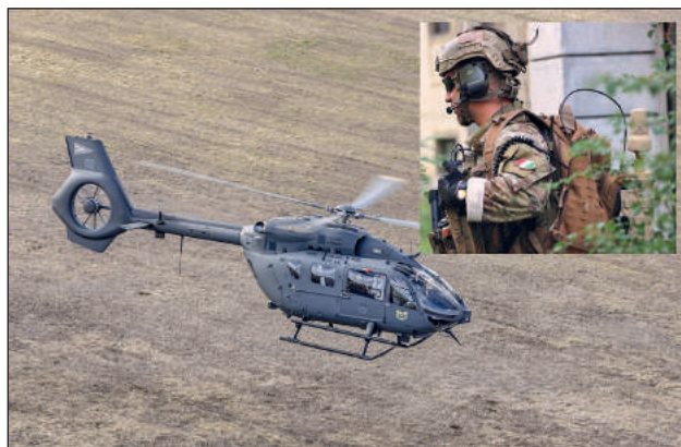
1. ábra. A Magyar Honvédség legkorszerűbb műholdas rádiórendszerei. A helikopter faroktartójának jobb oldalán a vezérsík előtt látható az UHF TACSAT rendszer antennája, a jobb oldali oldalajtó felett pedig az L-TAC/SlingShot rendszer antennája. A betétképen a különleges műveleti katonára felszerelésére rögzítve látható az L-TAC/SlingShot antenna (Forrás: honvedelem.hu és különlegesdandar.hu)
