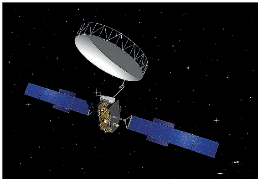
7. ábra. 14 sorozatú műhold kinyitott antennareflektozzal (Grafika – Forrás: ESA)
