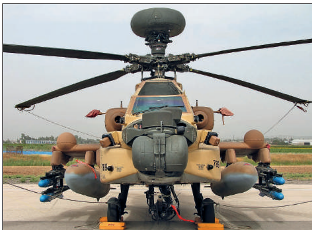
2. ábra. Az izraeli AH-64D Saraf harci helikoptert fejlett szenzorokkal szerelték fel, amelyek közül a legszembetűnőbb az AN/APG-78 (Longbow) milliméteres hullámhosszú tűzvezérlő radar célgyűjtő rendszere, valamint a radarfrekvencia interferométer. Mindkét eszköz a fő rotor feletti kupolában helyezkedik el (Forrás: jetphotos.net – ErezS)
