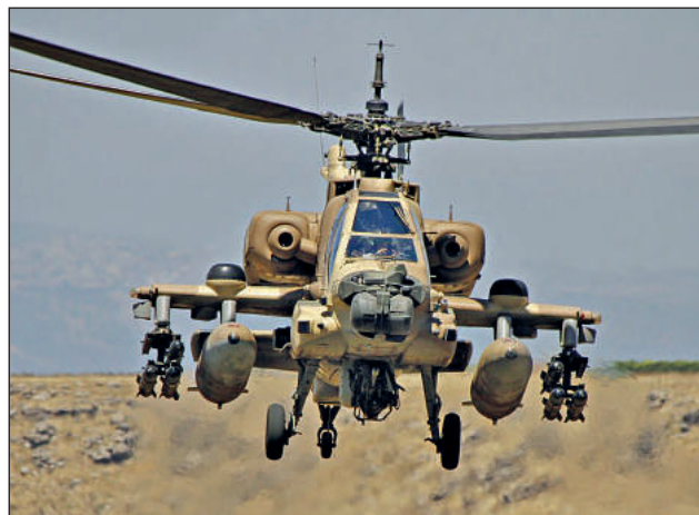
3. ábra. Izraeli AH-64A Peten harci helikopter. A félszárnyak felső részén láthatók a műholdas távközlési rendszer antennái, amelyek intenzív manőverezés közben is képesek követni a használt műholdat. A tényleges antennarendszer az áramvonalazó burkolat alatt található. (Forrás: Times of Israel)
