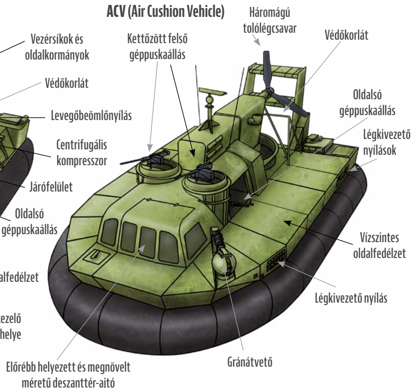
6. ÁBRA. A PACV és az ACV felépítése (Grafika: Földi Balázs)
