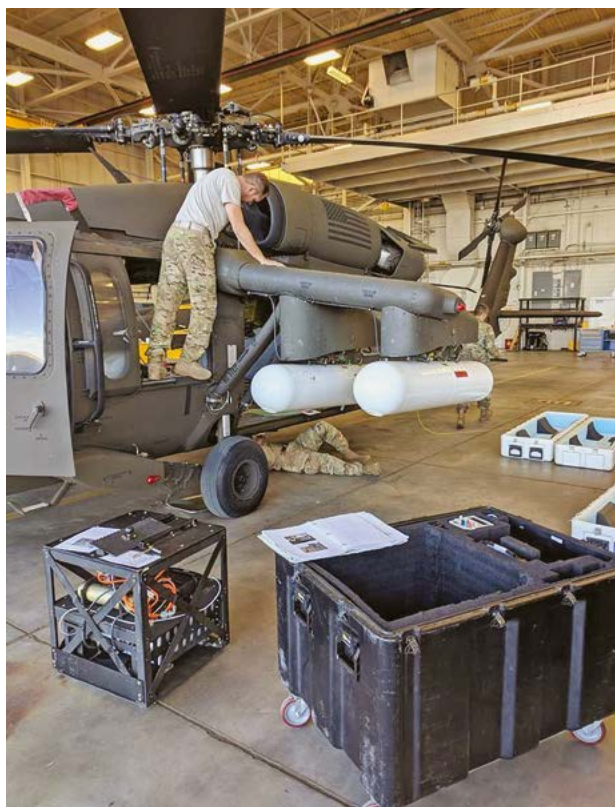
3. ÁBRA. A US Army légi sugárfelderítő konténer egy UH-60 Black Hawk típusú helikopteren [16]
