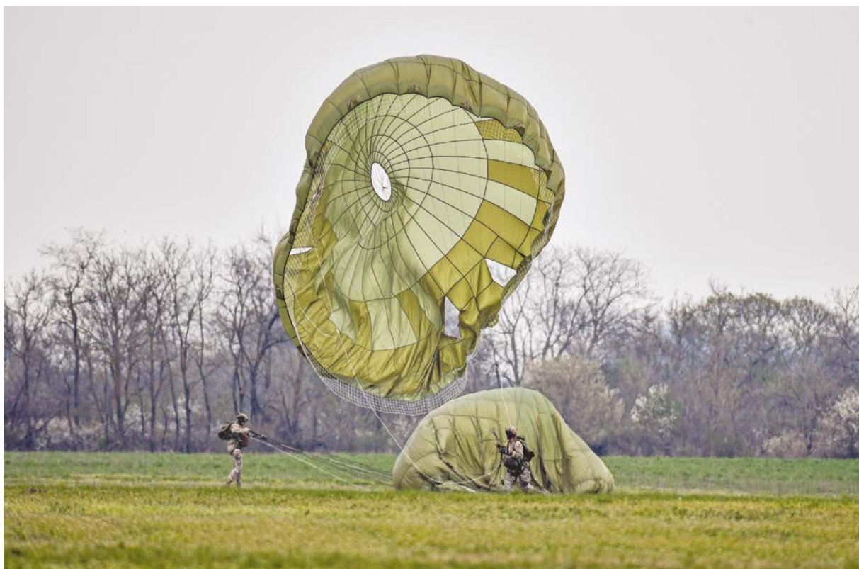
5. ÁBRA. OVP-12 SL-1, egy klasszikus körkupolás deszant ejtőernyő (Fotó: Zrínyi Nkft. / honvedelem.hu / Rácz Tünde)
