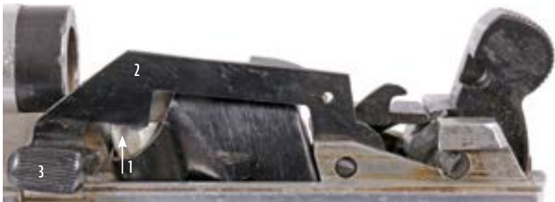
9. ÁBRA. Az M-9 pisztoly szánrógázító működése (A szerző szerkesztése, Szikits Péter felvételének felhasználásával) [1]
