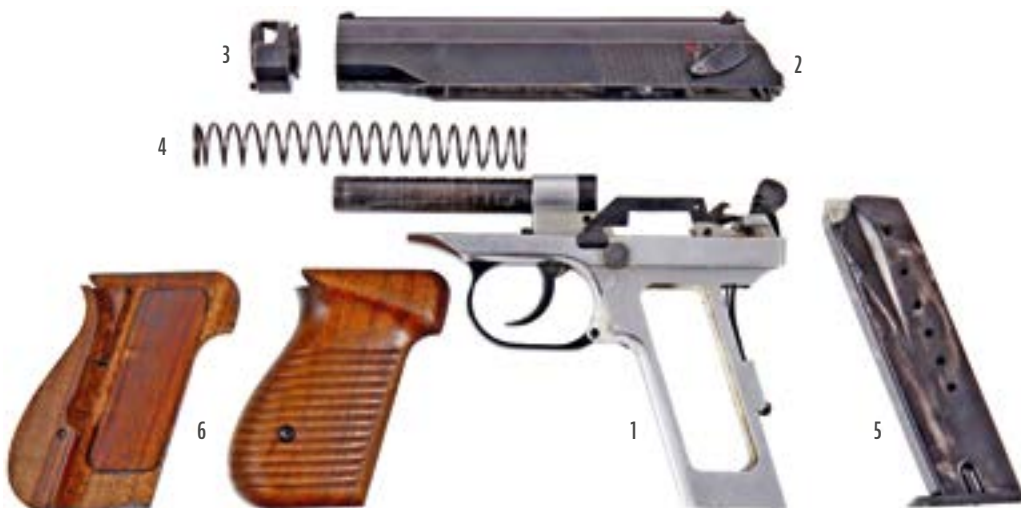
4. ÁBRA. Az M-9 pisztoly fő részei. 1. tok a csővel, a markolattal, az elsütőszerkezettel, a vezetőhornyokkal és a sátorvassal; 2. szán a célgömbbel, a nézőkével, az ütőszeggel, a biztosítóval, a vezetőlécekkal és a kivetőnyílással; 3. kompenzátor a bajonettzárval; 4. helyretoló rugó; 5. tölténytár az adogatótömbbel, az adogatórugóval, a tárfelekkel és rögzítőjével; 6. markolathéj (jobb, bal) (A szerző szerkesztése, Szikits Péter felvételének felhasználásával) [1]
