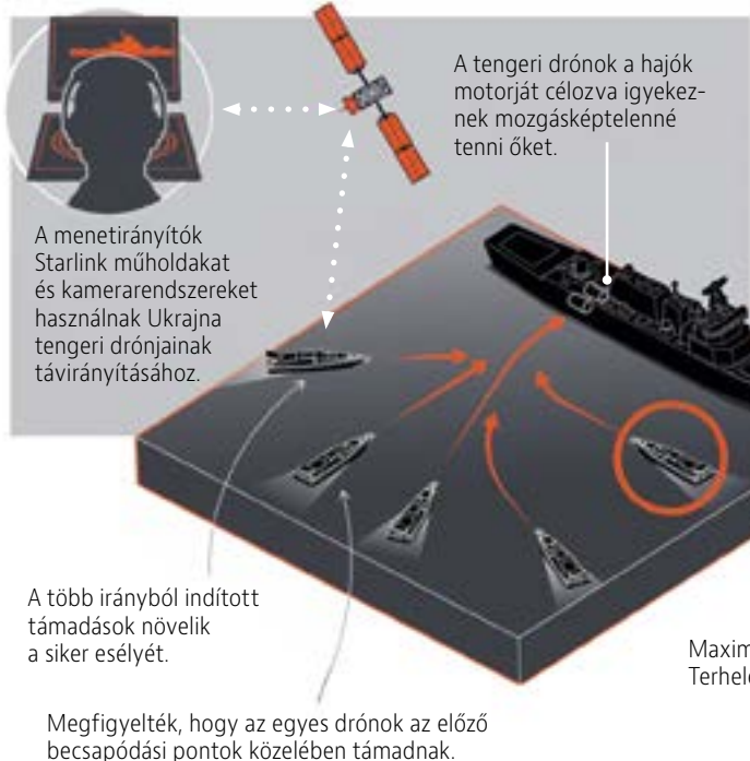
4. ÁBRA. A tengeri drónok szerkezete és bevetésük (A szerző szerkesztése a [9] alapján)
