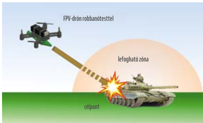
4. ÁBRA. FPV-drón becsapódása a cél tárgyra a távirányítás megszűnését követően (A szerzők szerkesztése)
