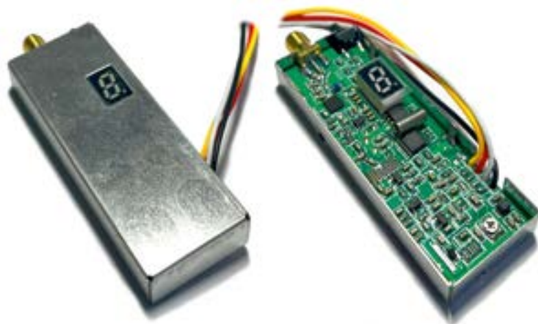
6. ÁBRA. Az orosz fél által közvetített videókból fellelhető TX1209-V20 megnevezésű VTX (A szerzők felvétele)
