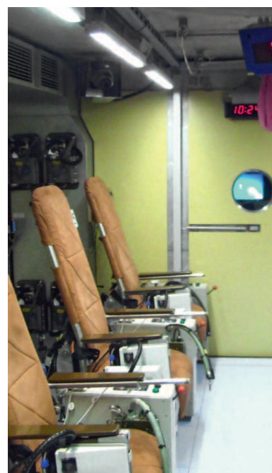
12. ÁBRA. A Német Légierő Repülőorvosi Intézet (Königsbrück) oxigénrendszerrel és pszichológiai tesztkészülékkel (Schufried), valamint LCD-kijelzővel felszerelt barokamrájának belső tere (A szerző felvétele az osztrák gyártócég AMST Ranshofen engedélyével)
