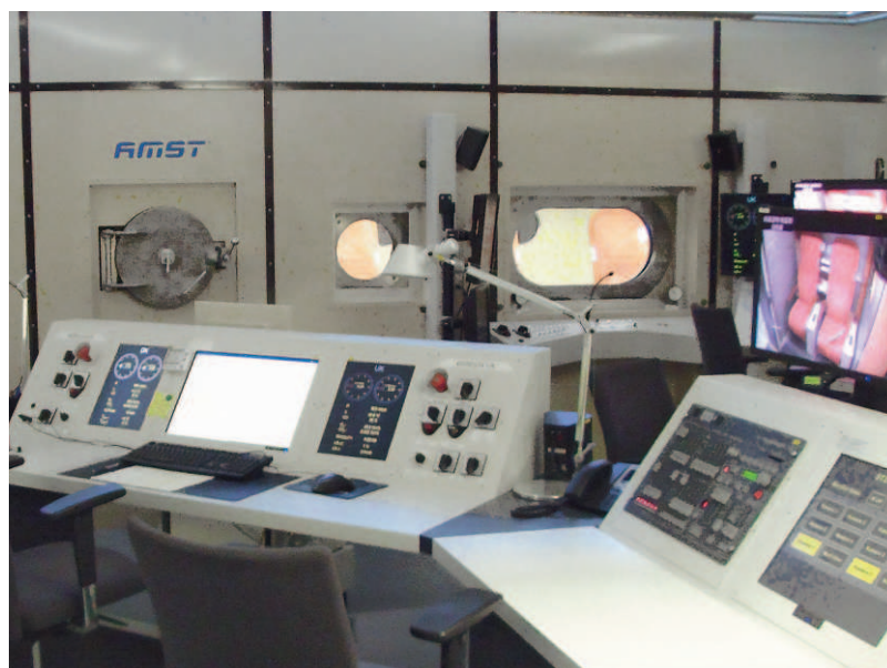
11. ÁBRA. A német légierő Repülőorvosi Intézet (Königsbrück) felújított barokamrájának műszaki és (a háttérben) orvosi pultja (A szerző felvétele az osztrák gyártócég AMST, Ranshofen engedélyével)
