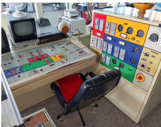
7. ÁBRA. Felső vezérlőszint: technikuspult és -szekrény (Schlumberger műszerek) (A szerző archívumából)
