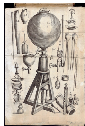
2. ÁBRA. Robert Boyle és Robert Hooke légszivattyús berendezése lég-ritkításra 1662-ben [2]
