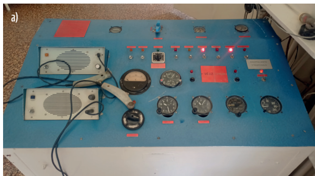
8. ÁBRA. A Gyáli úti RHTEK barokamra műszaki háttere: légszivattyú és műszaki pult (eredeti német feliratozással 1938-ból) (Fotók: Szilvási Zoltán oktatópilóta)
