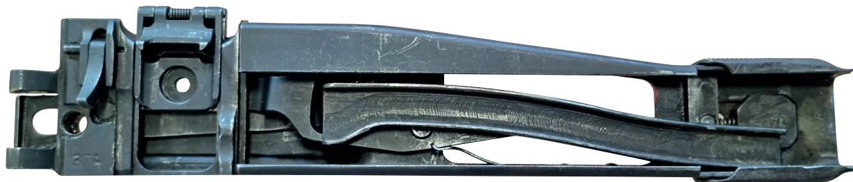
1. ÁBRA. Az RPD golyószóró – oktatási célból – preparált léptetőszerkezetének alulnézeti képe (A szerző felvétele)
