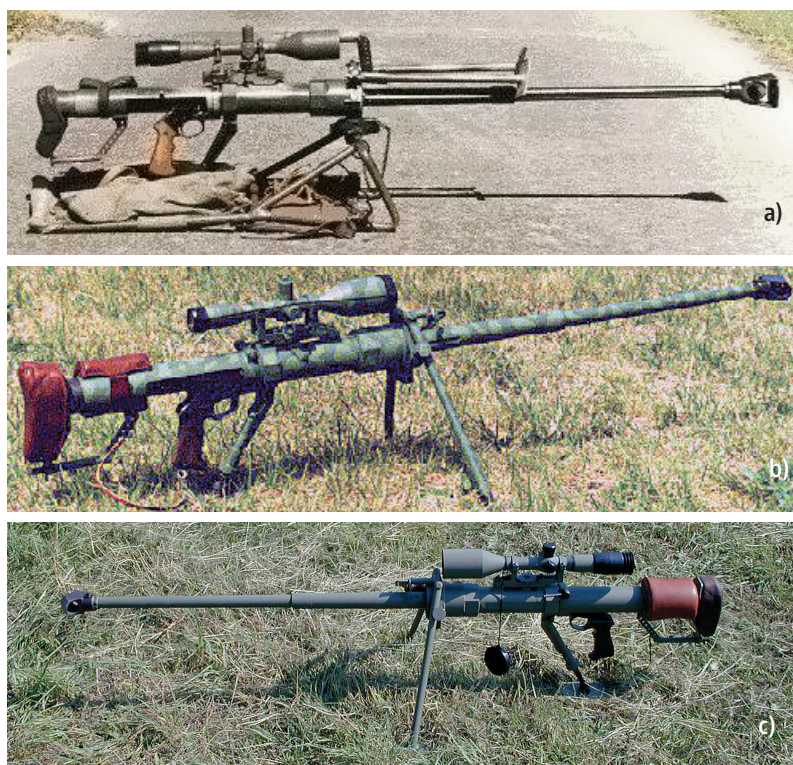
83. ÁBRA. A Gepárd M1 különböző festésű változatai: a) az első kísérleti rejtőszín egy M1A1-változaton; b) egy kevésbé csillogó foltos változatú M1; c) a végső változatú rejtőszín
