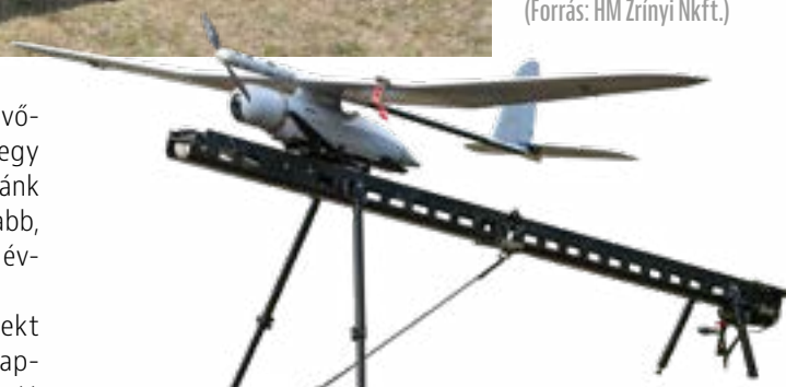
8. ÁBRA. A Skylark I-LEX pilóta nélküli repülőgép katapultos indítása (Forrás: HM Zrínyi Nkft.)
