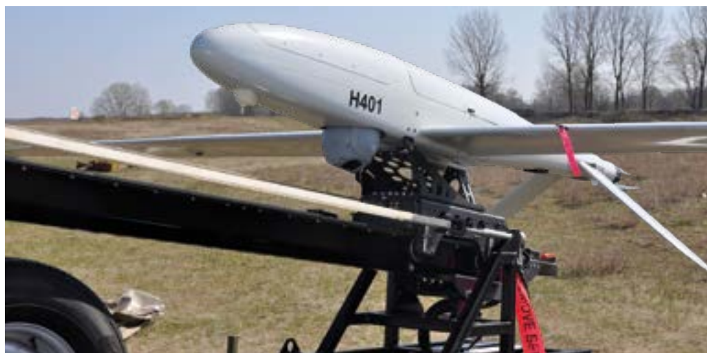
9. ÁBRA. A Skylark 3 közvetlenül felszállás előtt. A képen jól látható, hogy a biztonsági csapszeg még nincs eltávolítva (A szerző felvétele)
