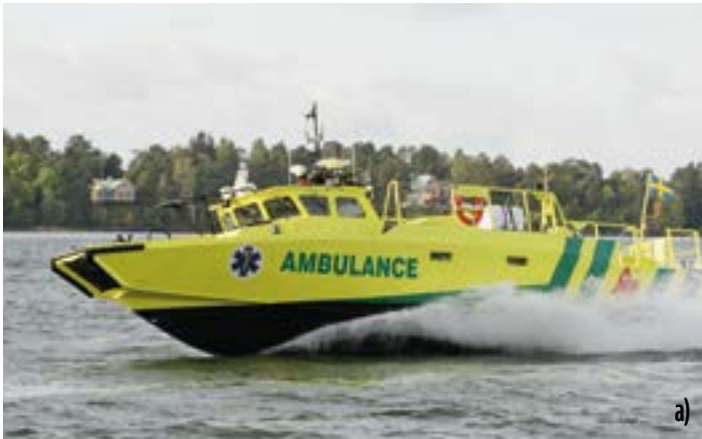
10. ÁBRA. Stridsbåt 90 SSRS mentőhajó a) és annak belső kialakítása b) [28]
