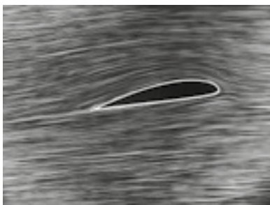
5. ÁBRA. A szárny állásszögének növekedésével kialakul az áramlás leválása a szárnyprofilon [7]
