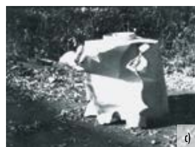
76. ÁBRA. A 12,7 mm-es B32 lövedék viselkedése egyes célyagokban: a) egy páncéllemezén történt áthatolás kimeneti nyílása; b) a lövedék behatolása 1 m vastag, fél méter magas földhányásba; c) a lövedék hatására felrobbant, vízzel feltöltött lemeztoner
