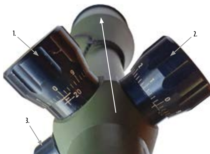
80. ÁBRA. A CSZ távcső finombeállítását biztosító részegységek: 1. magasságszög-beállító forgatógomb, 2. oldalszög-beállító forgatógomb, 3. szállémez-megvilágítás kapcsoló. A fehér nyíl a szemlencse irányából a tárgylencse irányába mutat
