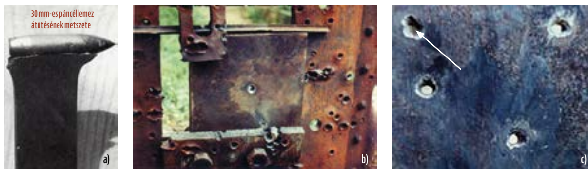
75. ÁBRA. Páncéllemez-átütések 100 méterről: a) egy 30 mm-es lemez átütésének függőleges középsíkjában készített metszet, a B32 lövedék utólag beleragasztott edzettacél magjával; b) 25 mm-es páncéllemez átütése; c) 20 mm-es páncéllemez átütése
