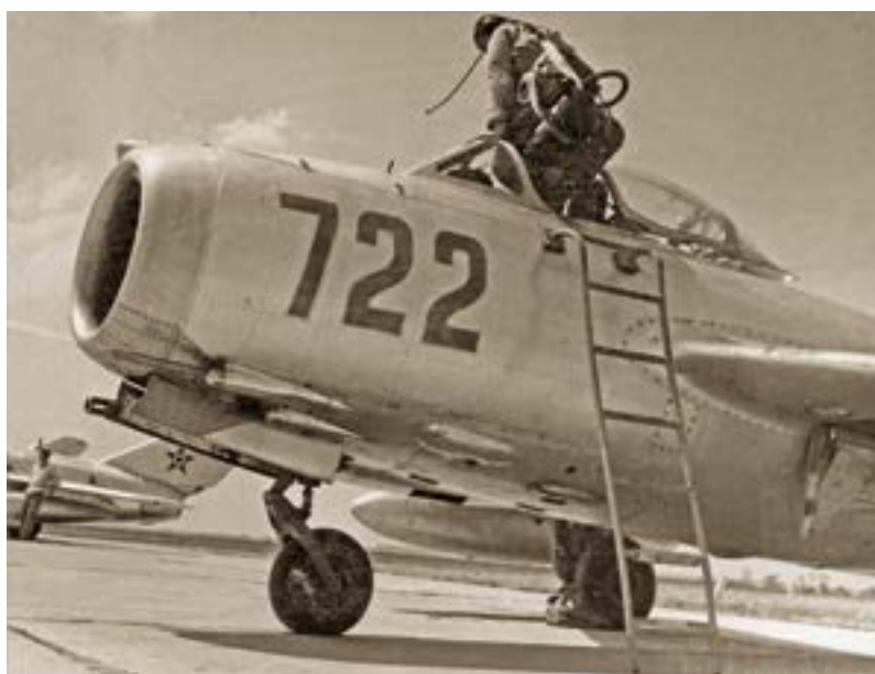
1. ÁBRA. A MiG-15bis vadászrepülőgép orr-része NR-23 és N-37D gépágyúval (Forrás: Hadtörténeti Múzeum, Fotógyűjtemény 59186. számú kép)
