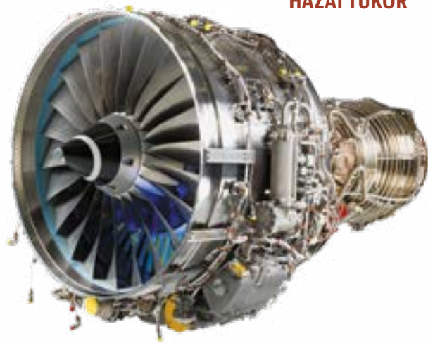
6. ÁBRA. Az International Aero Engines által gyártott V2500-as hajtómű [9]
