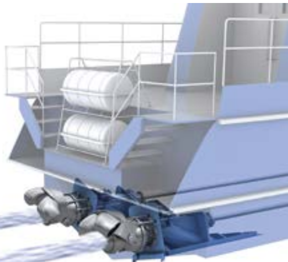
5. ÁBRA. A Rolls-Royce Kamewa FF víz-sugarárhajtómű működését illusztráló grafika [6]
