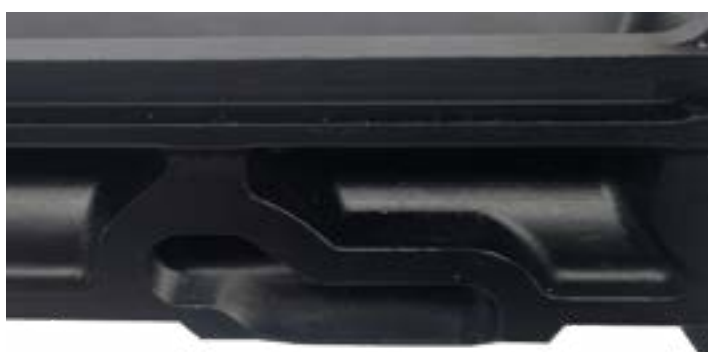
18. ÁBRA. Alámetszés nélküli cikloidális kényszerpálya egy zárkereten (A szerző felvétele, a Gestamen Zrt. engedélyével)
