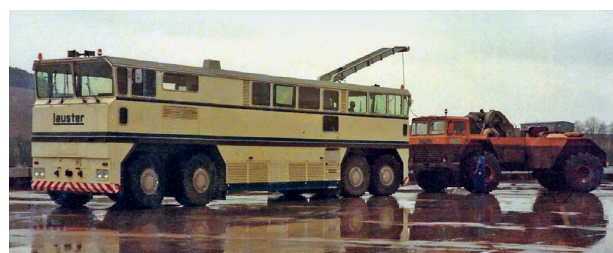
17. ÁBRA. Az MF 60 mérőjármű egy FML vonatát tesztel. Jól látszanak a tető mellső részén lévő kültéri hangszórók, illetve a tető hátsó részéből kiemelt vezetékartó sín is [5]
