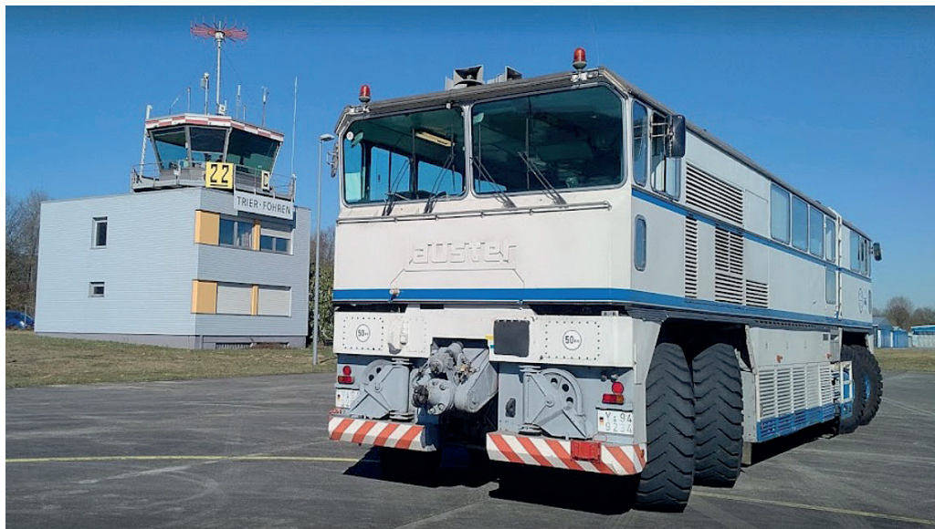
9. ÁBRA. Az MF 60 mérőjármű a trieri repülőtér betonján. Jól látszik a négy tengely kormányozhatósága [5]
