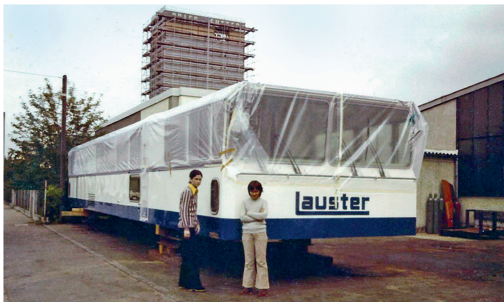
18. ÁBRA. Az MF 60 mérőjármű felépítménye a hordozóvázalattal történő összeszerelés előtt [5]
