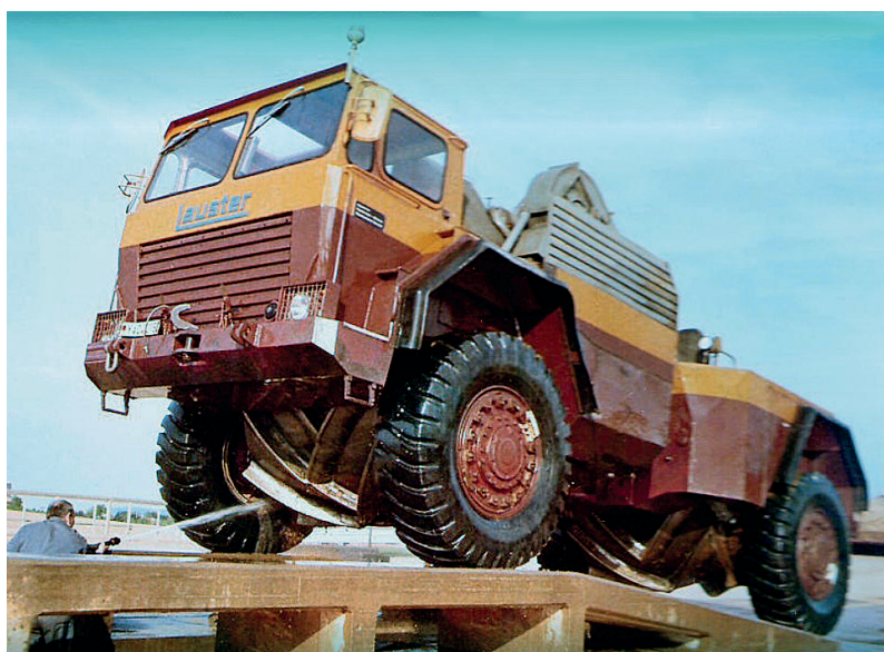
12. ÁBRA. A Lauster FML a mosórámpán. A jármű alvázán jól láthatóak a központi meghajtódob halveszálkamintás kapaszkodófelületei [5]
