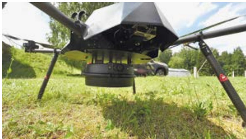
10. ÁBRA. A „Szitakötő” optikai kamerája és radarja [8]
