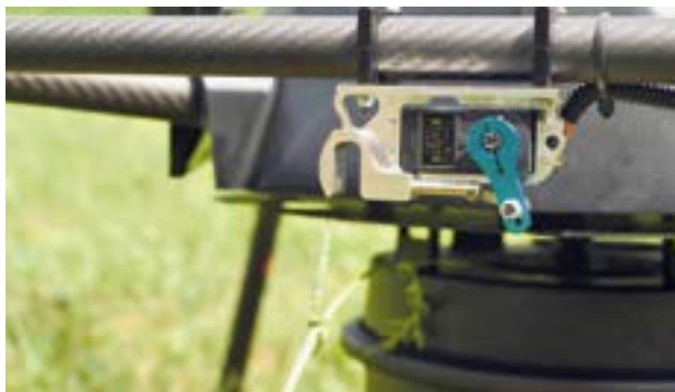
15. ÁBRA. A teherhordó zárszerkezet nyitott helyzetben [8]
