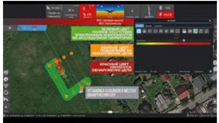
14. ÁBRA. A programozott/megtett útvonal és a megtalált robbanóeszközök jelölése [8]
