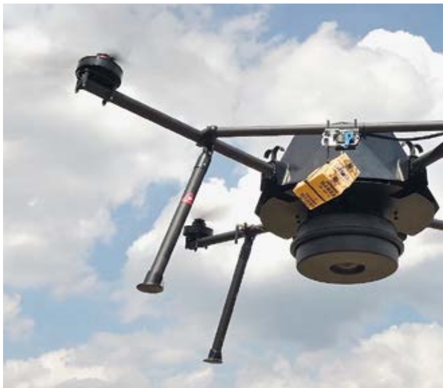
11. ÁBRA. A „Szitakötő” töltésszállítás közben [8]
