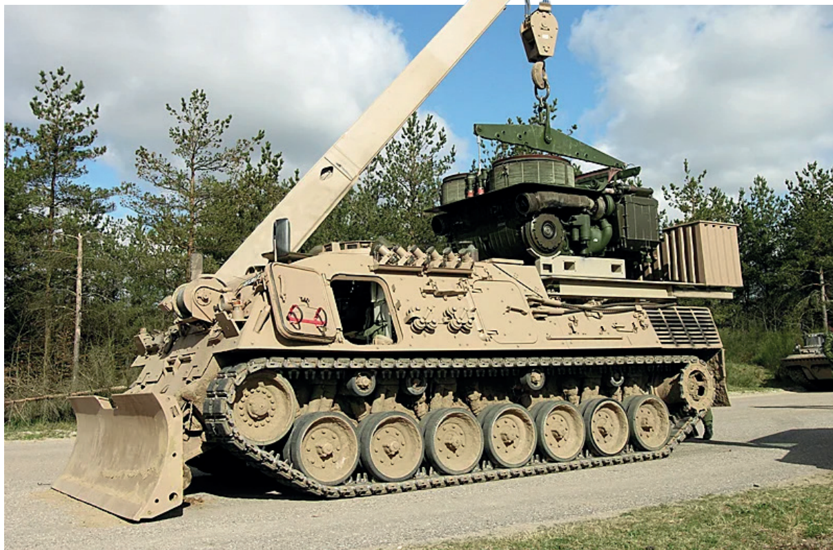
26. ÁBRA. Wisent 1 a motor- és erőátviteli blokk emelése közben [32]
