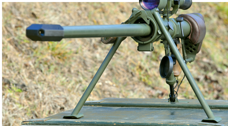
64. ÁBRA. A melső villaláb és a fogantyúszerkezet szembenézetben (Fotó: HM Zrínyi Nkft. / Rác Tünde)
