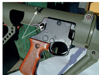
50. ÁBRA. A „szemletüske” a szerelt tusacsó oldalán, és a kakas furata fehér nyilakkal jelölve (Fotó: Tikász Gyula)
